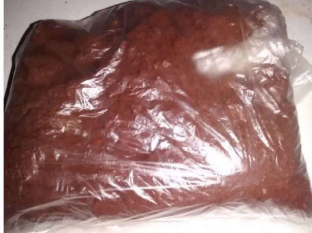
Figura 13 - Acondicionamento do solo antes da realização da moldagem dos CPs
