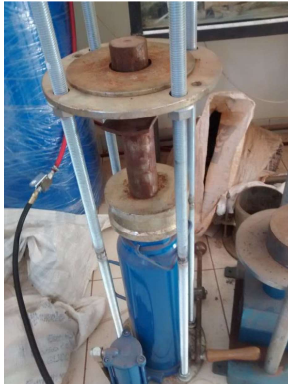
Figura 14 - Macaco de ar comprimido utilizado para moldagem dos CPs
