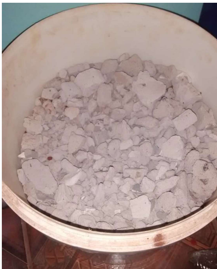
Figura 6 – Resíduos cimentícios britados e separados para realização das amostras
