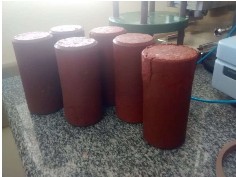
Figura 17 - CPs após rompimento
