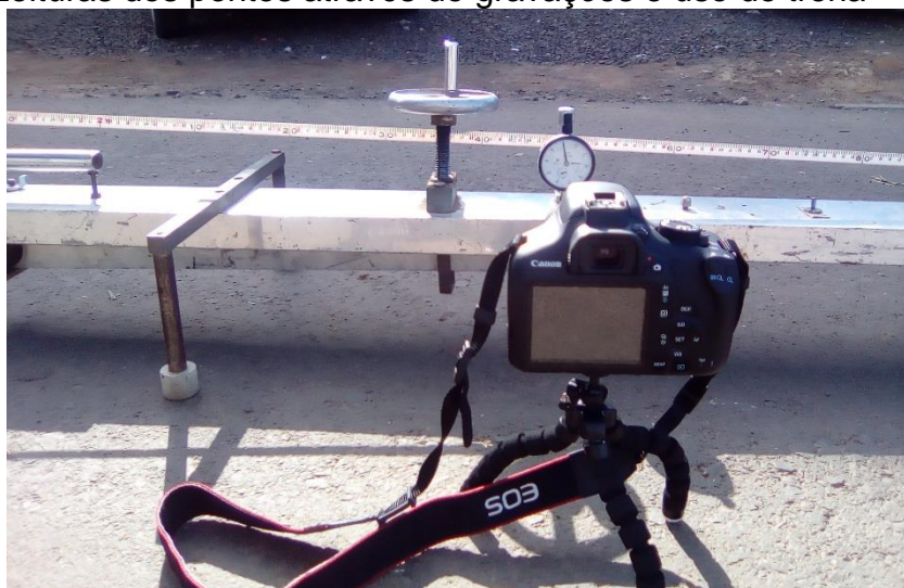
Figura 21 – Leituras dos pontos através de gravações e uso de trena
