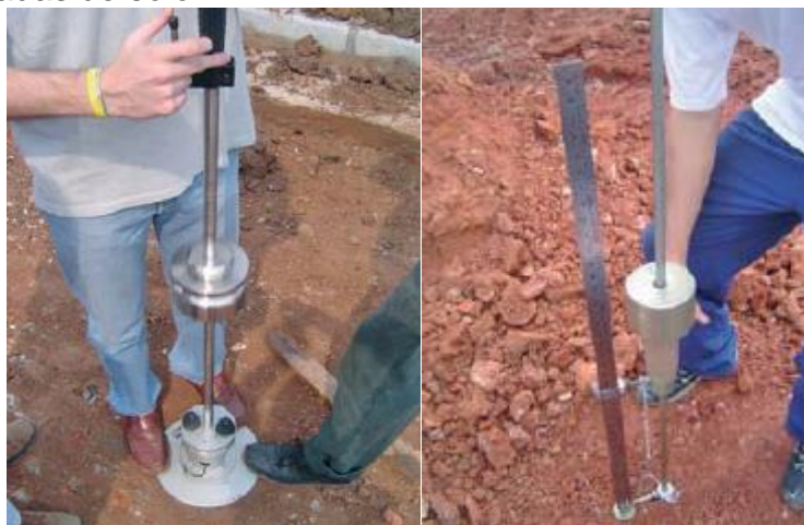
Figura 1 – Exemplo de equipamentos DCP de avaliação estrutural expedita de subleitos e camadas de solo
