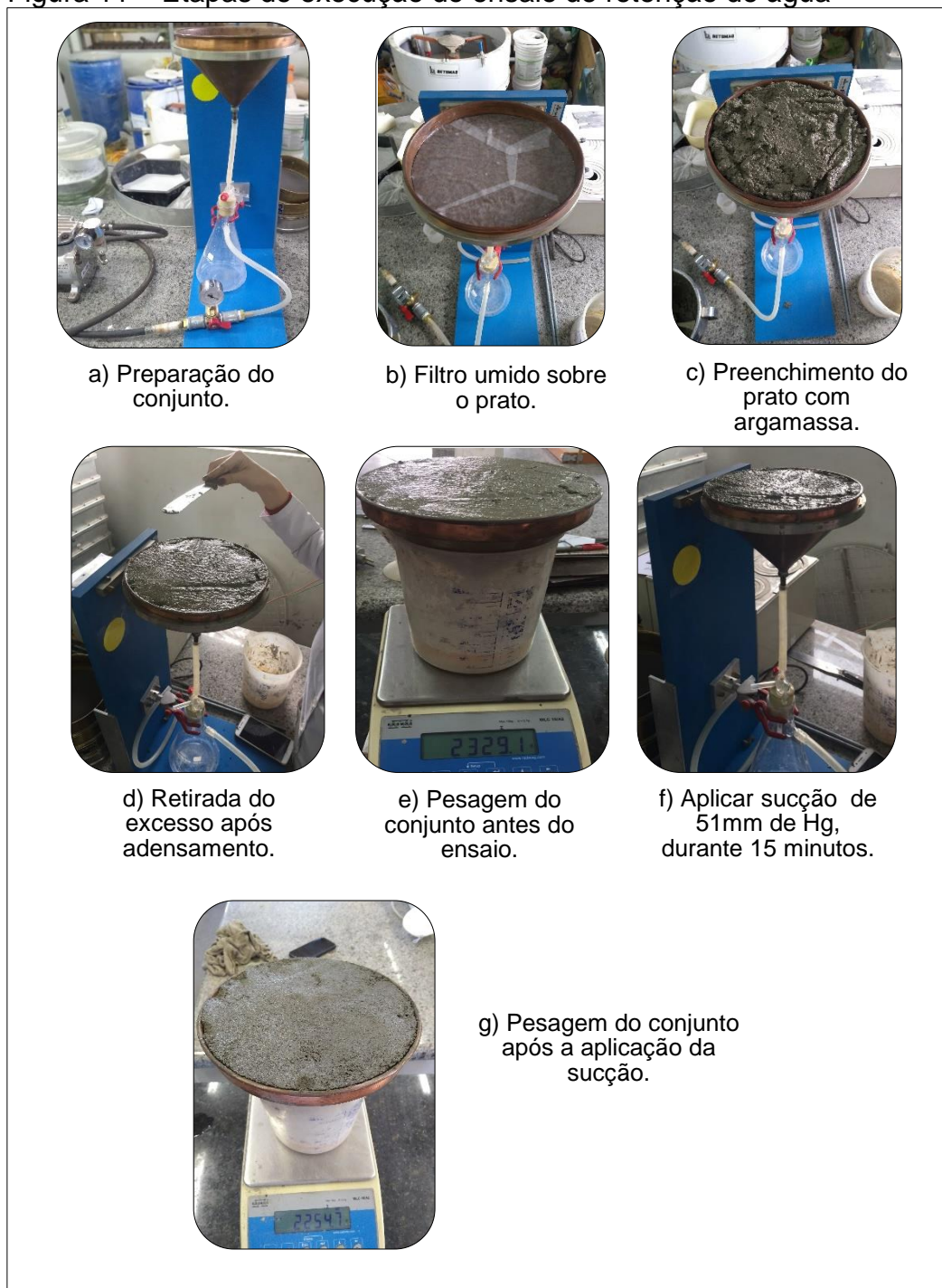
Figura 11 – Etapas de execução do ensaio de retenção de água
