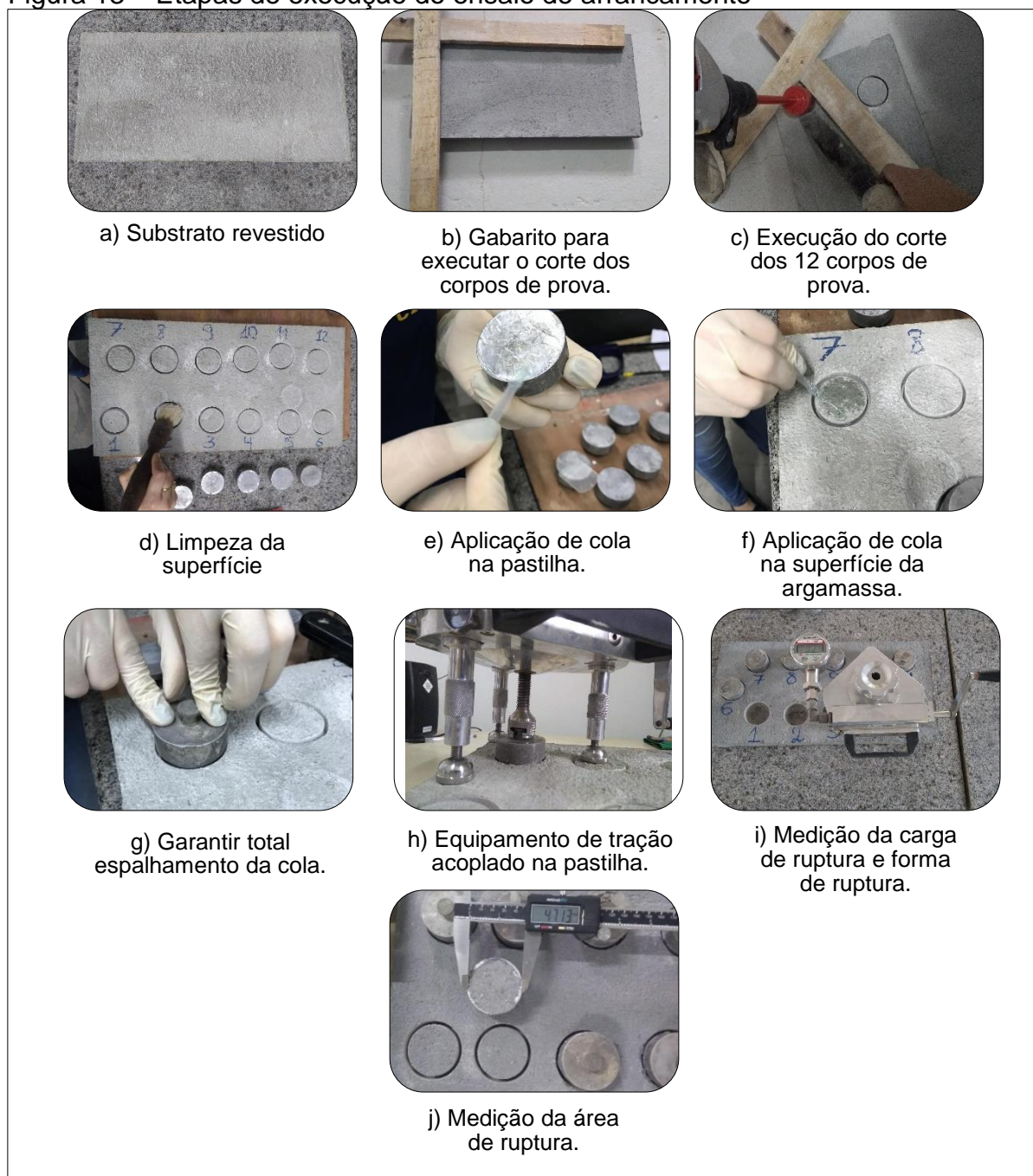
Figura 13 – Etapas de execução do ensaio de arrancamento
