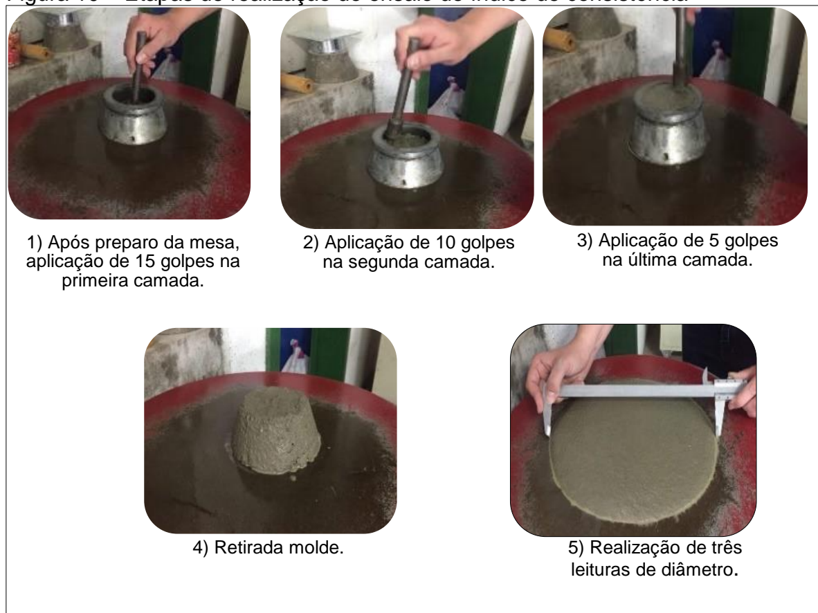
Figura 10 – Etapas de realização do ensaio de índice de consistência
