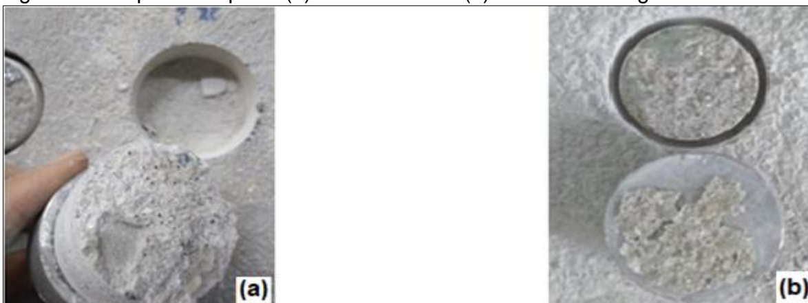
Figura 15 – Tipos de ruptura (a) no substrato e (b) na interface argamassa-cola
