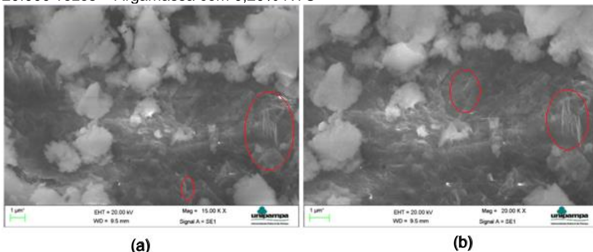
Figura 17 - Imagem MEV com (a) ampliação de 15.000 vezes e (b) ampliação de 20.000 vezes – Argamassa com 0,20% NTC
