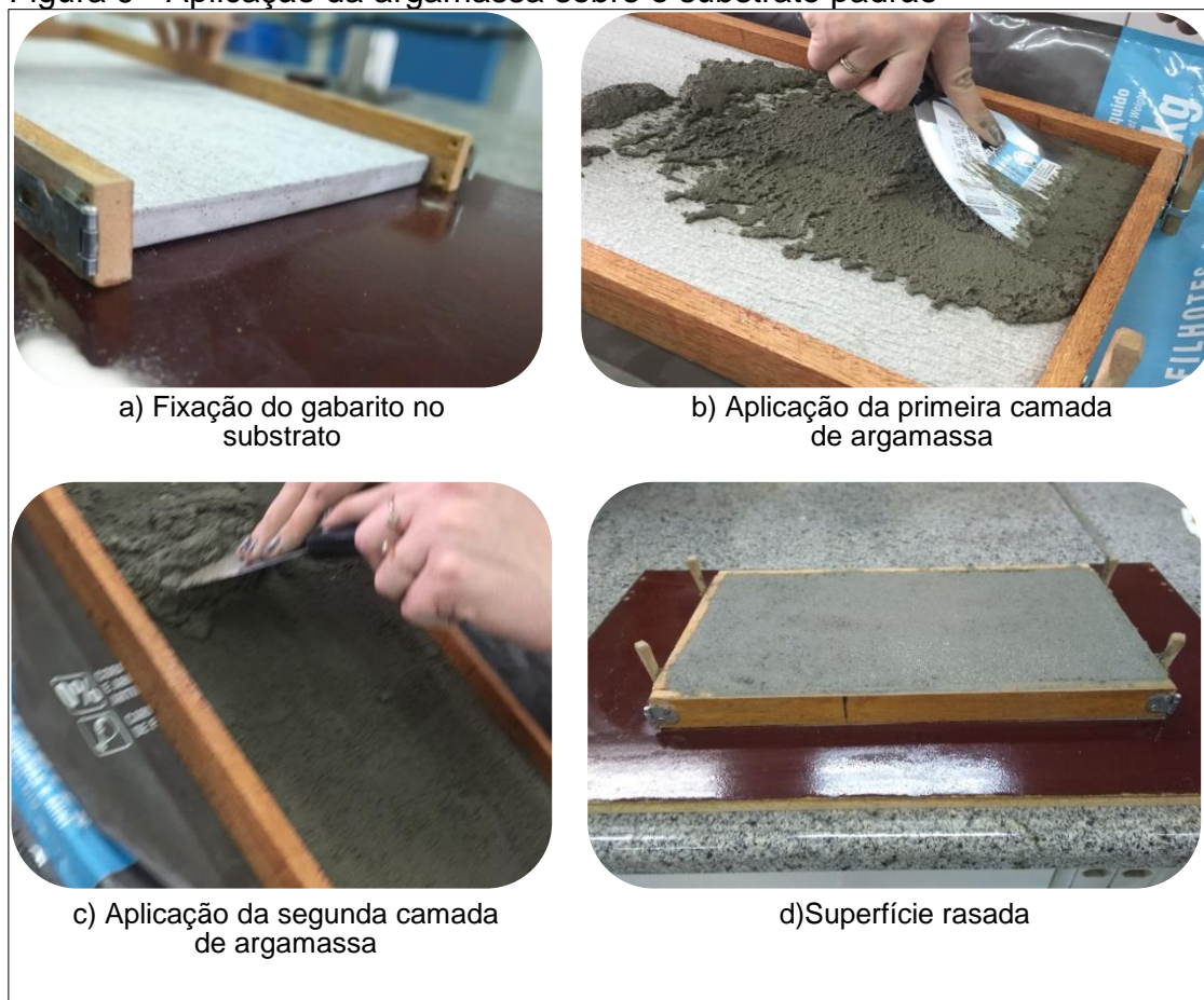
Figura 9 - Aplicação da argamassa sobre o substrato padrão
