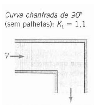
Figura 4 - Coeficiente de perda de carga localizada.
