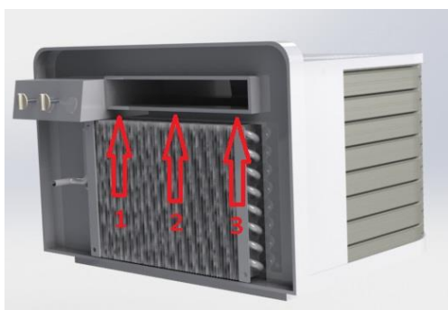
Fig. 17 - Posição das tomadas de velocidade na saída do evaporador.
