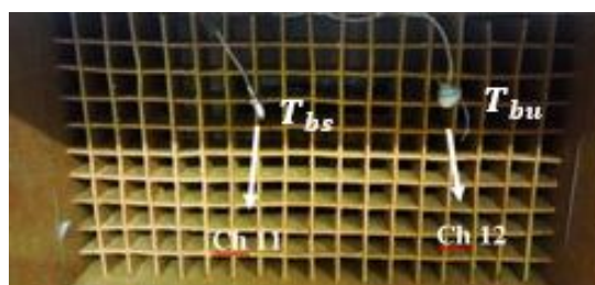
Fig. 38 - Termopares instalados no interior da câmara plena (saída do evaporador ou ar de insuflamento).
