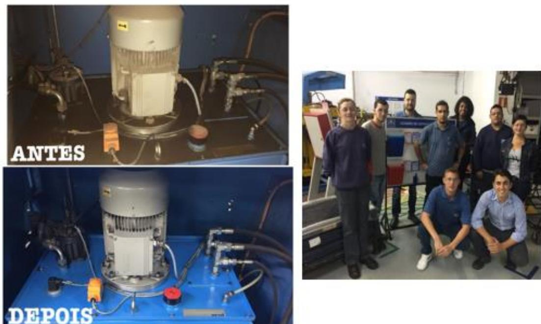
A seguir, a máquina foi submetida a uma análise crítica e criteriosa de anomalias e seu respectivo registro em etiquetas semelhantes às da figura 4. Estas etiquetas quando preenchidas, foram penduradas na própria máquina para visualização de seu estado geral, e recuperação futura para suas condições originais
