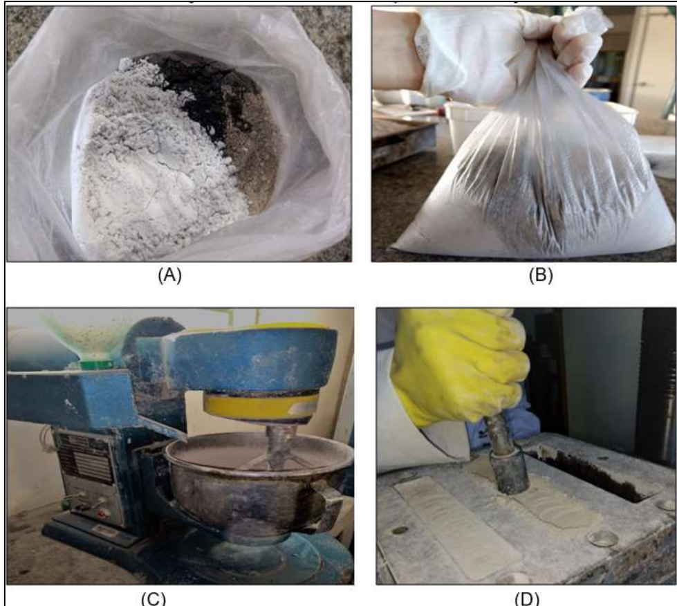
Figura 28- Etapas de mistura e preenchimento dos moldes: (A) União das matérias-primas para pré-mistura; (B) Etapa de pré-mistura das matérias-primas em saco plástico; (C) Homogeneização da mistura em misturador planetário; (D) Inserção da mistura no molde para conformação
