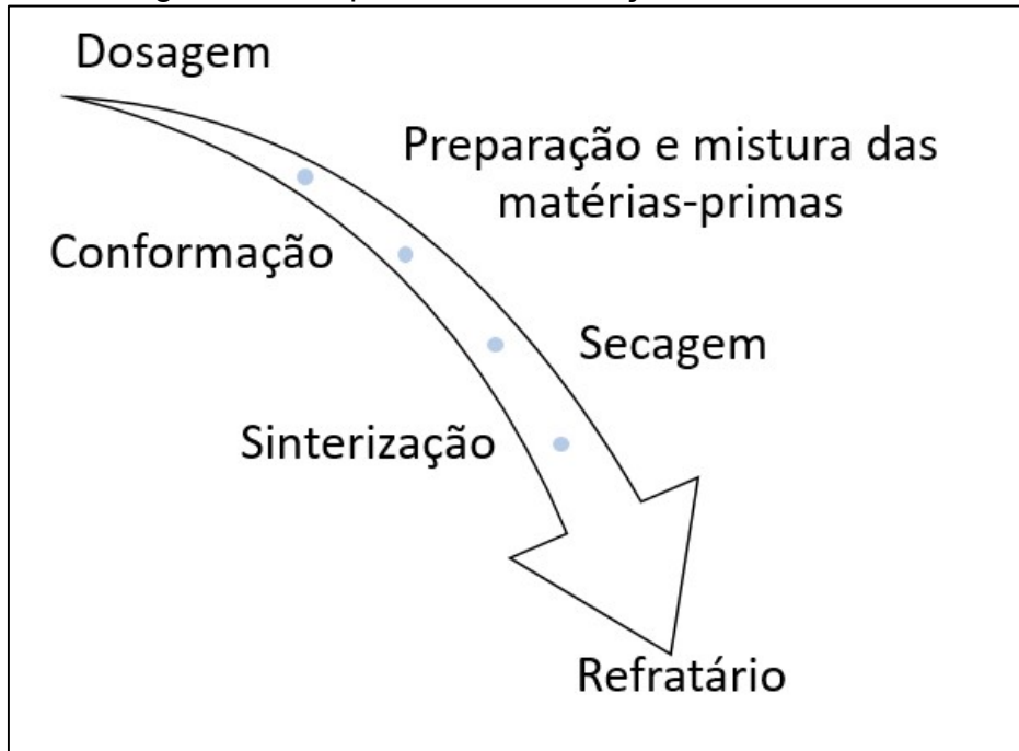
Figura 26- Sequência de fabricação dos refratários
