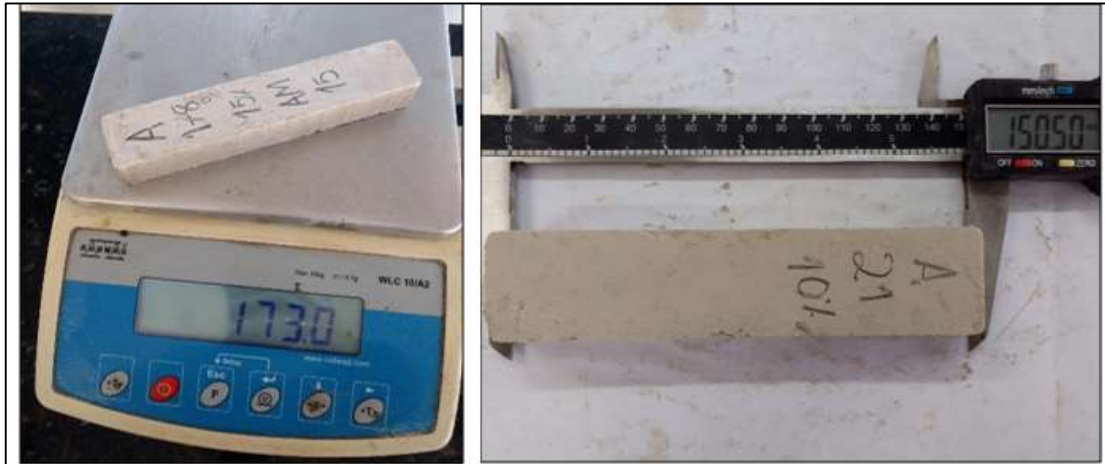
Figura 34- Controle da etapa de secagem: (A) Pesagem das amostras; (B) Aferição das dimensões.
