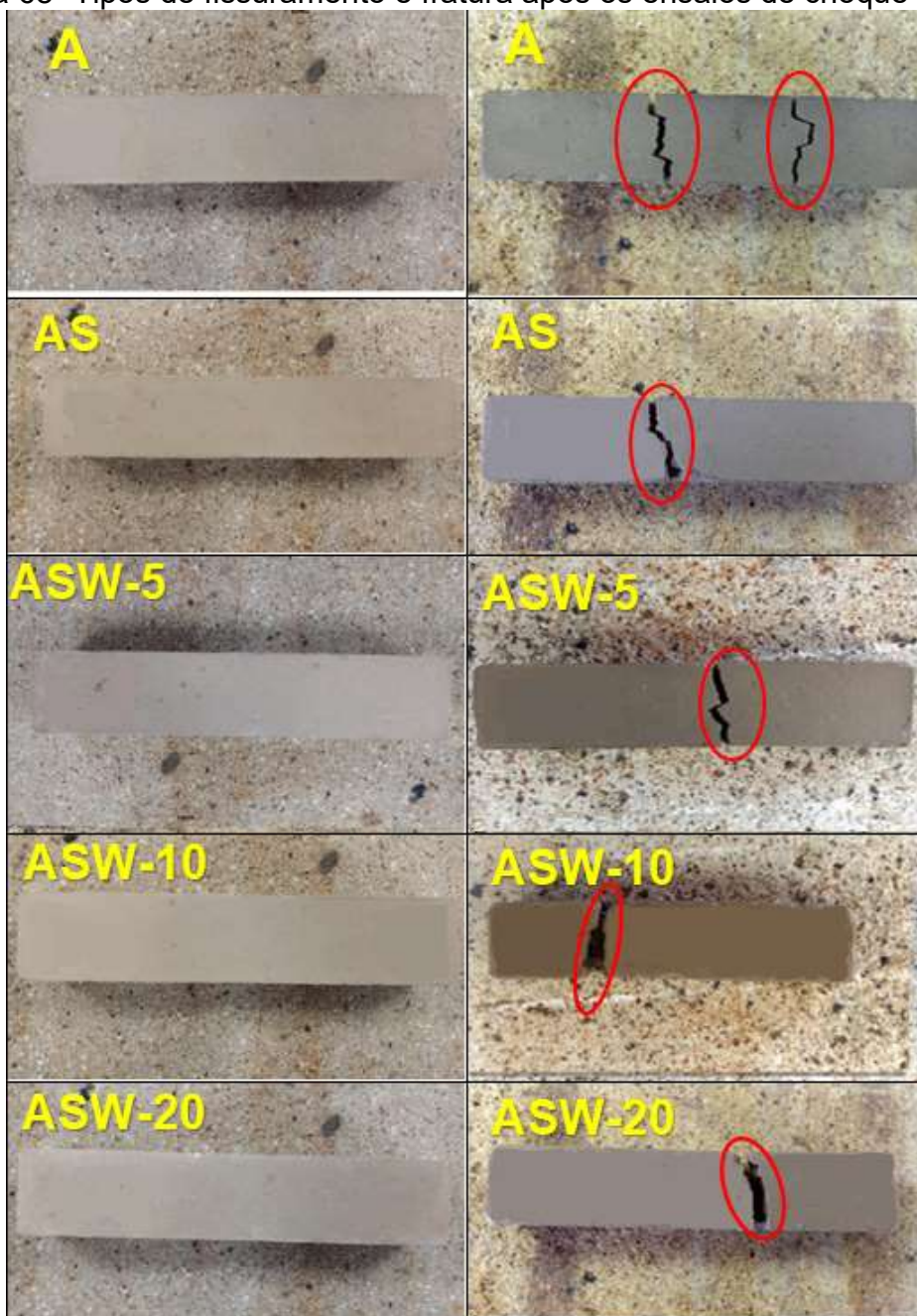
Figura 68- Tipos de fissuramento e fratura após os ensaios de choque-térmico
