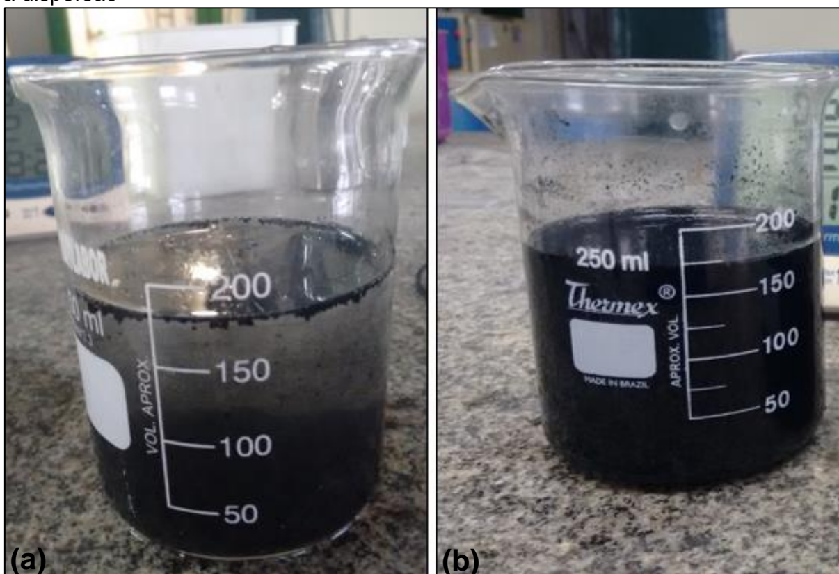
Figura 14 – Dispersão dos NTCs: (a) Solução antes da dispersão; (b) Solução após a dispersão
