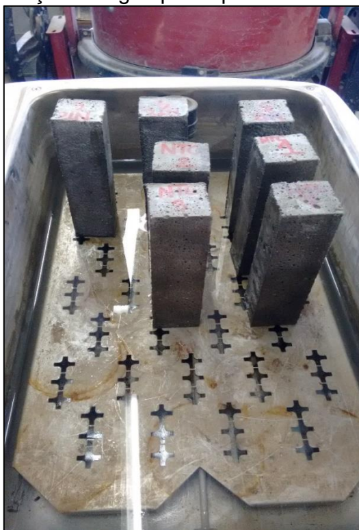
Figura 18- Ensaio de absorção de água por capilaridade
