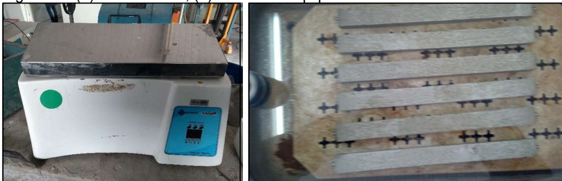
Figura 8 – (a) Banho Maria, (b) interior do equipamento
