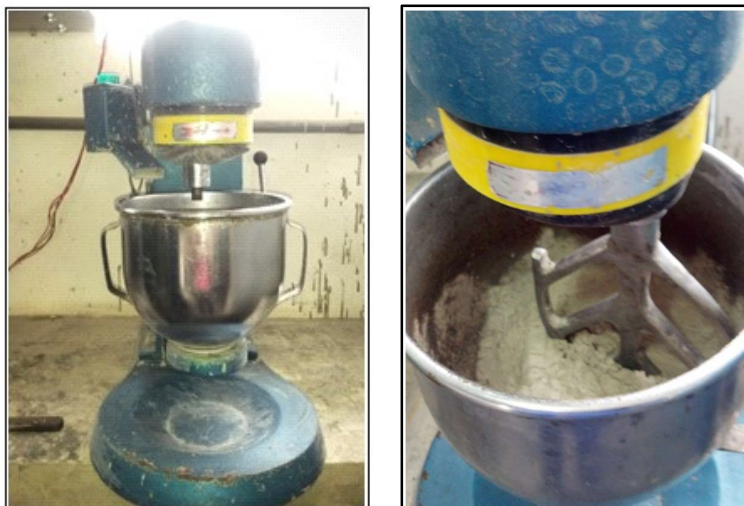
Figura 4 – (a) Misturador mecânico, (b) produção de argamassa no misturador
