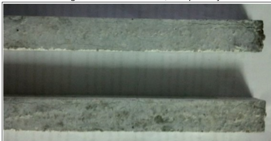
Figura 12 – Barras de argamassa da mistura M4, com presença de fissuras
