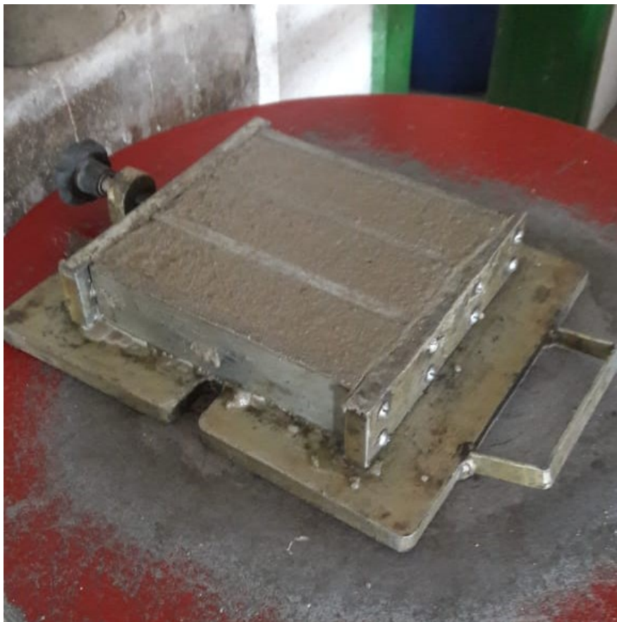
Figura 7 – Corpos de prova moldados na forma
