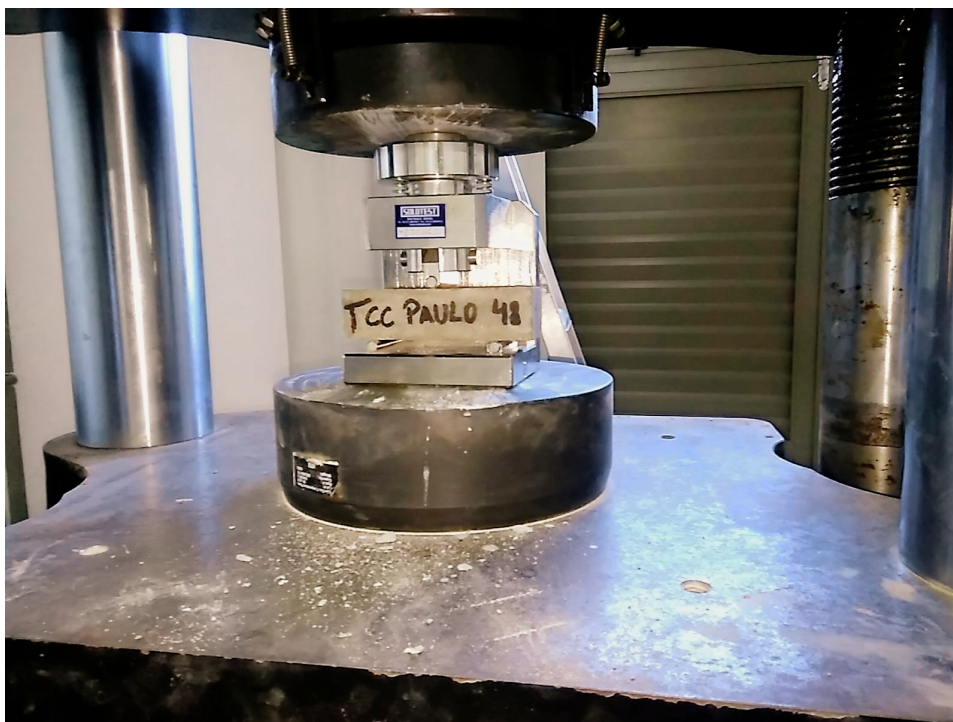
Figura 8 – Ensaio de tração na flexão
