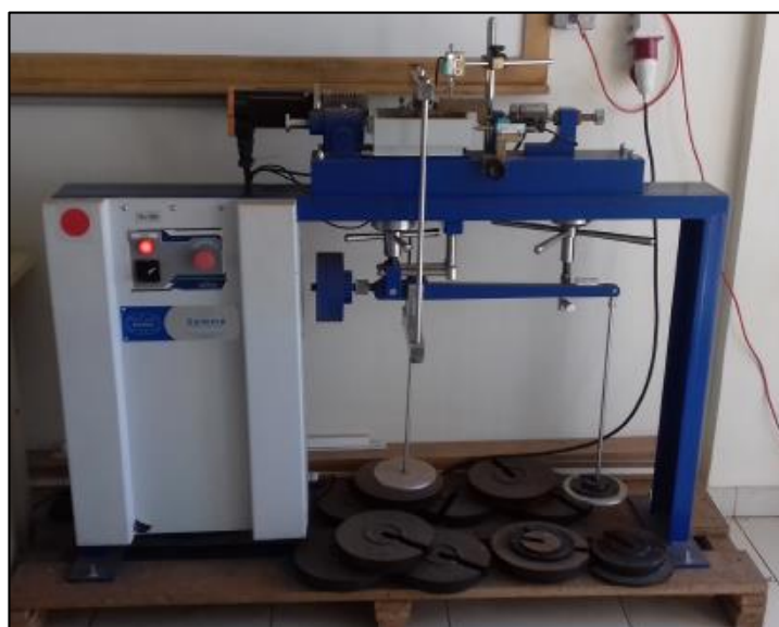
Figura 16 - Equipamento de Ensaio de Cisalhamento Direto
