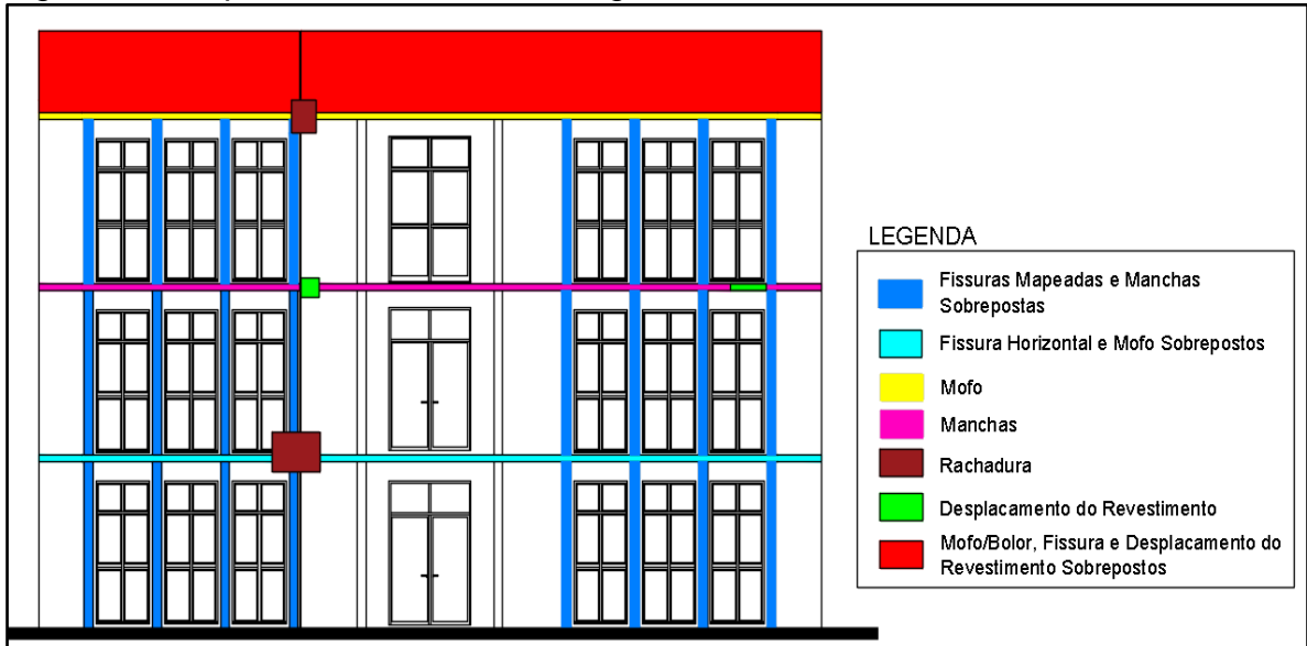
Figura 62- Mapa de Incidências Patológicas do Prédio Administrativo – Prumada 3
