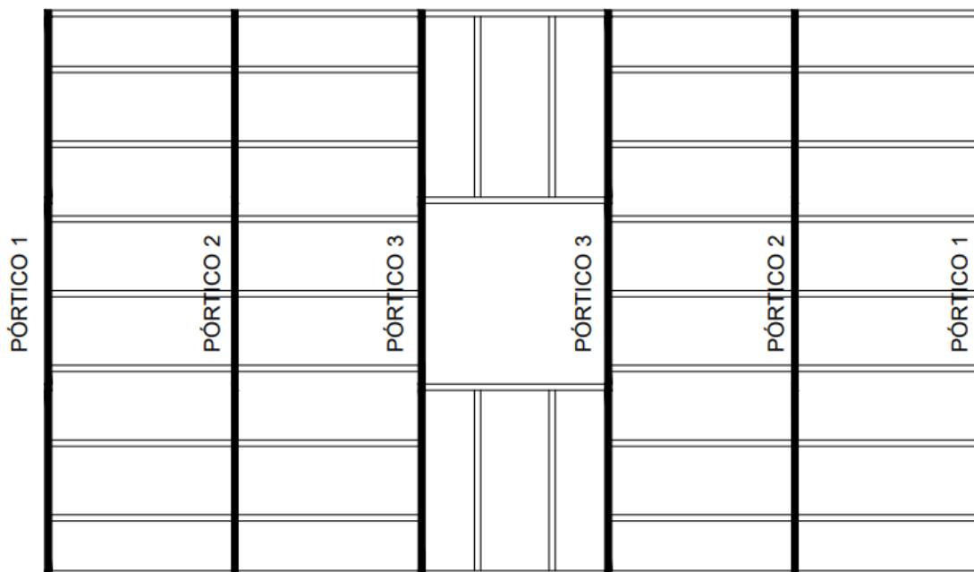
Figura 24 – Disposição pórticos rígidos
