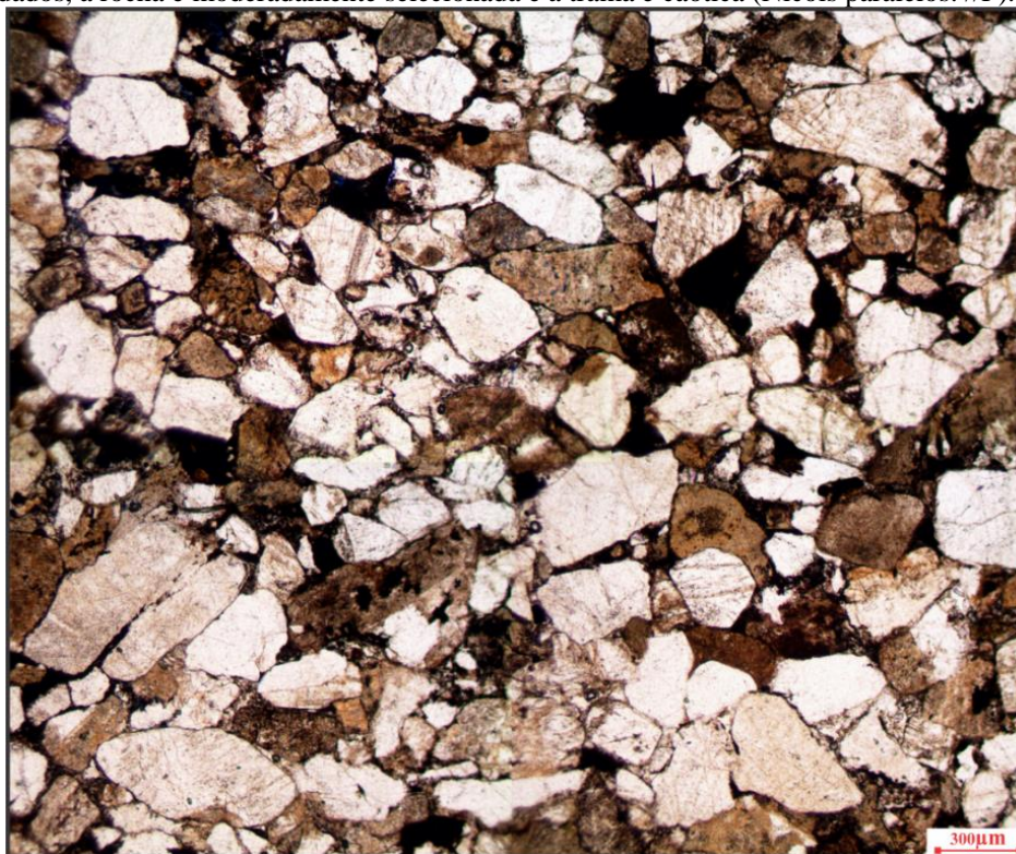
Figura 13 – Aspecto textural dos arenitos da associação CAF. Arenitos grossos com estrutura maciça, os grãos são sub-arredondados, a rocha é moderadamente selecionada e a trama é caótica (Nicóis paralelos: //P).
