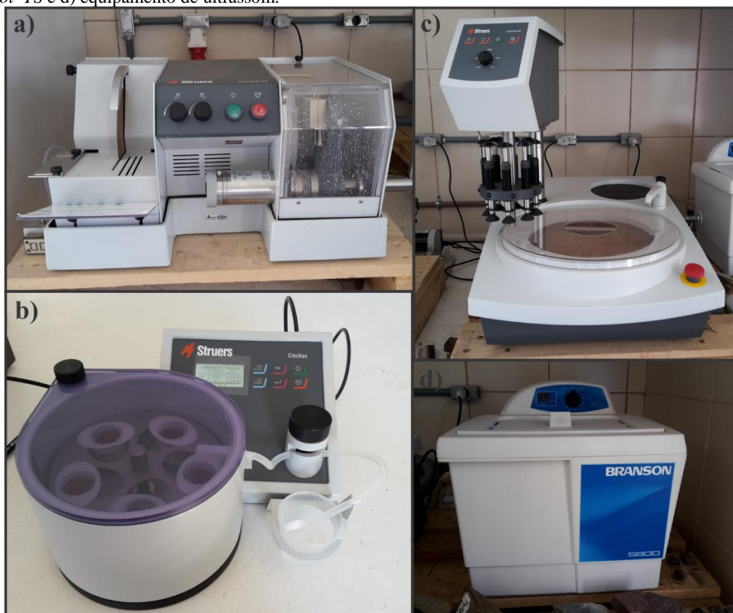
Figura 6 – Equipamentos utilizados para a confecção das lâminas delgadas. a) Discoplan-TS , b) CitoVac , c) Labopol-TS e d) equipamento de ultrassom.
