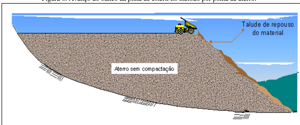
Figura 8: Avanço do banco da pilha de estéril no método por ponta de aterro.
