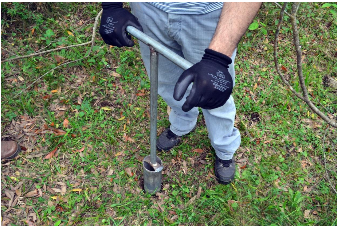
Figura 7 - Fotografia do trado manual usado para coleta das amostras de solo.
