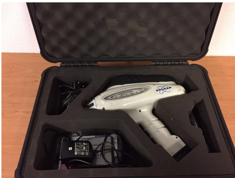
Figura 9 - Fotografia equipamento de EDXRF portátil S1 Turbo SD Bruker.
