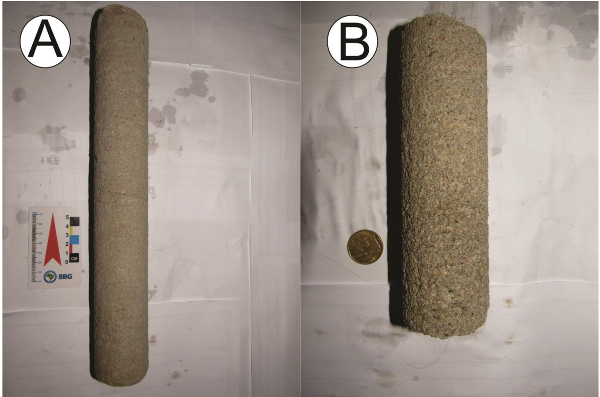
Figura 38 - Arenitos maciços. (fácies 2A) . A) Arenitos grossos com estrutura maciça. B) Arenitos muito grossos com estrutura maciça.
