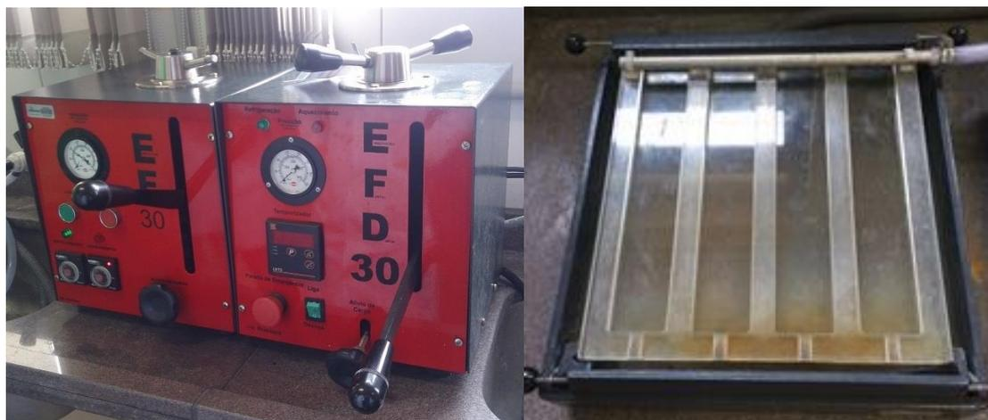
Figura 6: Embutidora e lixadeira que são utilizadas no processo. Fonte: Acervo próprio.
