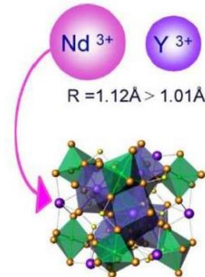
Figura 2 : Estrutura atômica de Nd:YAG: os íons de  $\text{Nd}^{3+}$  substituem os de  $\text{Y}^{3+}$  na matriz cristalina. Fonte: KANCHANA VELEERAT E. et al., 2004.
