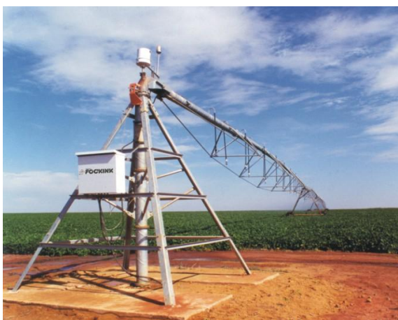
Figura 1: Equipamento para irrigação pivô central.
