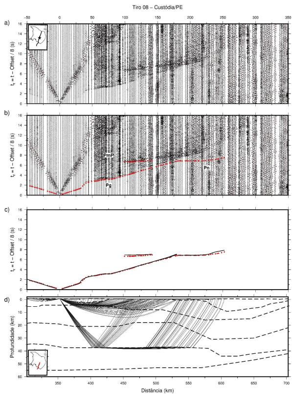
Figura 18 - Seção sísmica de ondas P do ponto de tiro SP-09 e os ajustes obtidos na modelagem. a) Seção sísmica processada; b) seção sísmica com as leituras (círculos vermelhos); c) diagrama dos ajustes obtidos para os tempos de trânsito teórico (linhas pretas) calculados para o modelo; d) diagrama de raios teóricos associados ao modelo obtido.
