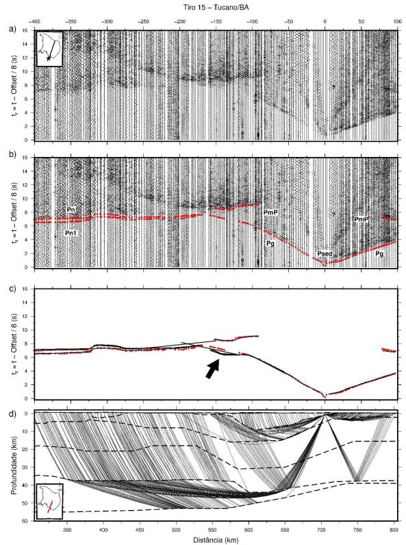
Figura 22 - Seção sísmica de ondas P do ponto de tiro SP-17 e os ajustes obtidos na modelagem. a) Seção sísmica processada; b) seção sísmica com as leituras (círculos vermelhos); c) diagrama dos ajustes obtidos para os tempos de trânsito teórico (linhas pretas) calculados para o modelo; d) diagrama de raios teóricos associados ao modelo obtido.
