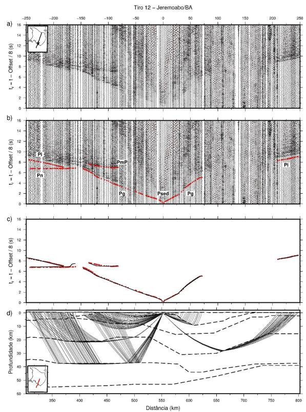
Figura 21 - Seção sísmica de ondas P do ponto de tiro SP-15 e os ajustes obtidos na modelagem. a) Seção sísmica processada; b) seção sísmica com as leituras (círculos vermelhos); c) diagrama dos ajustes obtidos para os tempos de trânsito teórico (linhas pretas) calculados para o modelo, seta preta indica seguimento das leituras de tempo de trânsito para o qual não foi possível obter um ajuste satisfatório; d) diagrama de raios teóricos associados ao modelo obtido.
