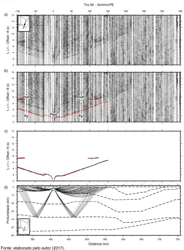
Figura 19 - Seção sísmica de ondas P do ponto de tiro SP-11 e os ajustes obtidos na modelagem. a) seção sísmica processada; b) seção sísmica com as leituras (círculos vermelhos); c) diagrama dos ajustes obtidos para os tempos de trânsito teórico (linhas pretas) calculados para o modelo; d) diagrama de raios teóricos associados ao modelo obtido.
