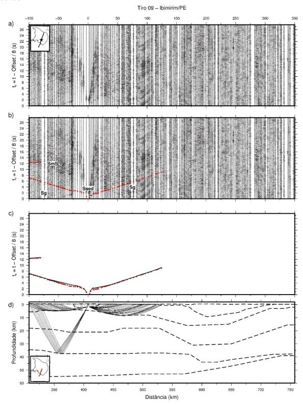
Figura 26 - Seção sísmica de ondas S do ponto de tiro SP-11 e os ajustes obtidos na modelagem. a) Seção sísmica processada; b) seção sísmica com as leituras (círculos vermelhos); c) diagrama dos ajustes obtidos para os tempos de trânsito teórico (linhas pretas) calculados para o modelo; d) diagrama de raios teóricos associados ao modelo obtido.
