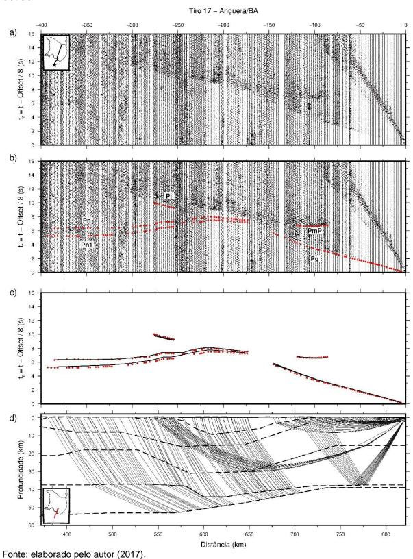
Figura 23- Diagramas: a) de ajuste obtido para os tempos de trânsito teóricos (linhas pretas) às leituras de tempo de trânsito(círculos vermelhos) dos 6 pontos de tiro utilizados; e b) de raios teóricos associados ao modelo de onda P da porção sul do perfil sísmico N-S.
