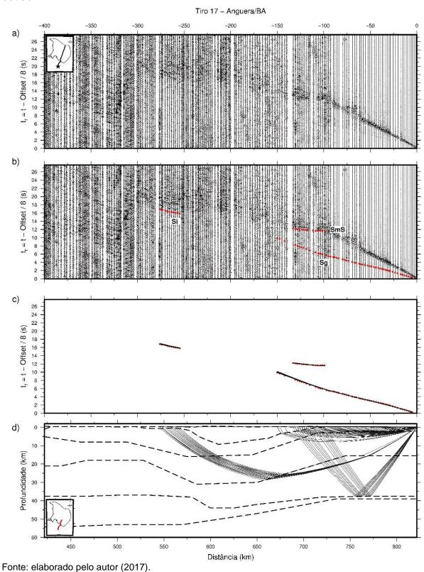
Figura 30 -Diagramas: a) de ajuste obtido para os tempos de trânsito teóricos (linhas pretas) às leituras de tempo de trânsito(círculos vermelhos) dos 6 pontos de tiro utilizados; e b) de raios teóricos associados ao modelo de onda P da porção sul do perfil sísmico N-S.
