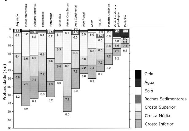
Figura 6 - Modelos crustais de velocidade da onda P.
