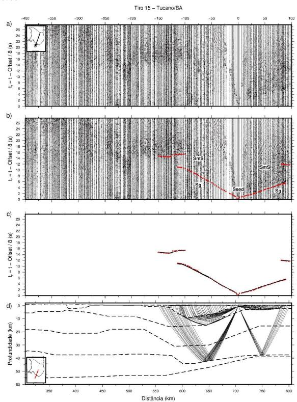
Figura 29 - Seção sísmica de ondas S do ponto de tiro SP-17 e os ajustes obtidos na modelagem. a) Seção sísmica processada; b) seção sísmica com as leituras (círculos vermelhos); c) diagrama dos ajustes obtidos para os tempos de trânsito teórico (linhas pretas) calculados para o modelo; d) diagrama de raios teóricos associados ao modelo obtido.
