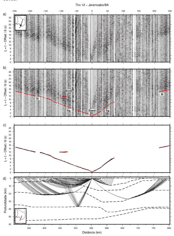
Figura 28 - Seção sísmica de ondas S do ponto de tiro SP-15 e os ajustes obtidos na modelagem. a) Seção sísmica processada; b) seção sísmica com as leituras (círculos vermelhos); c) diagrama dos ajustes obtidos para os tempos de trânsito teórico (linhas pretas) calculados para o modelo; d) diagrama de raios teóricos associados ao modelo obtido.
