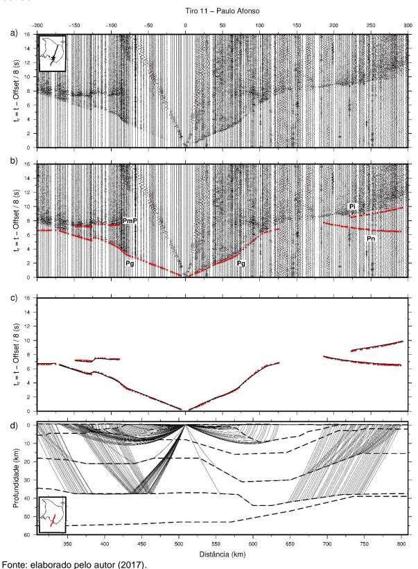
Figura 20 - Seção sísmica de ondas P do ponto de tiro SP-12 e os ajustes obtidos na modelagem. a) Seção sísmica processada; b) seção sísmica com as leituras (círculos vermelhos); c) diagrama dos ajustes obtidos para os tempos de trânsito teórico (linhas pretas) calculados para o modelo; d) diagrama de raios teóricos associados ao modelo obtido.
