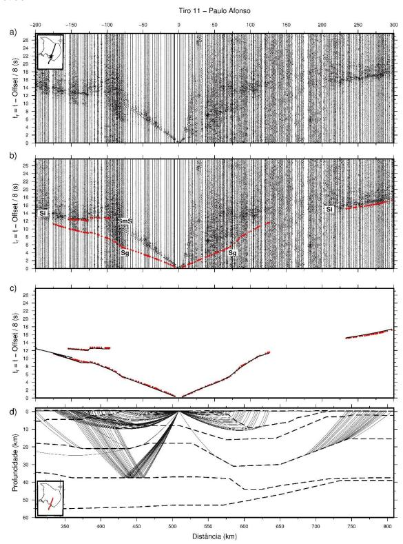
Figura 27 - Seção sísmica de ondas S do ponto de tiro SP-12 e os ajustes obtidos na modelagem. a) Seção sísmica processada; b) seção sísmica com as leituras (círculos vermelhos); c) diagrama dos ajustes obtidos para os tempos de trânsito teórico (linhas pretas) calculados para o modelo; d) diagrama de raios teóricos associados ao modelo obtido.
