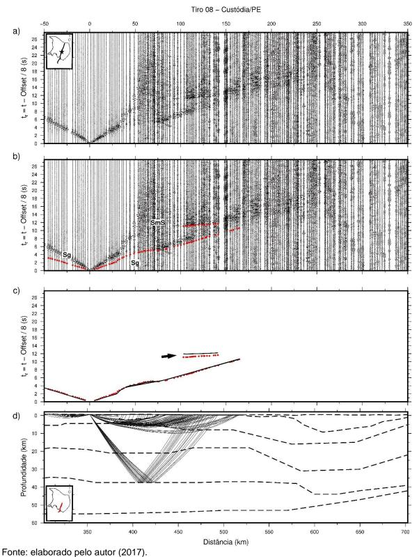
Figura 25 - Seção sísmica de ondas S do ponto de tiro SP-09 e os ajustes obtidos na modelagem. a) Seção sísmica processada; b) seção sísmica com as leituras (círculos vermelhos); c) diagrama dos ajustes obtidos para os tempos de trânsito teórico (linhas pretas) calculados para o modelo; d) diagrama de raios teóricos associados ao modelo obtido.
