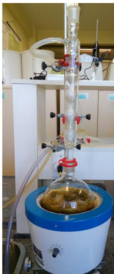
Figura 17- Procedimento e materiais utilizados na etapa de deslignificação.
