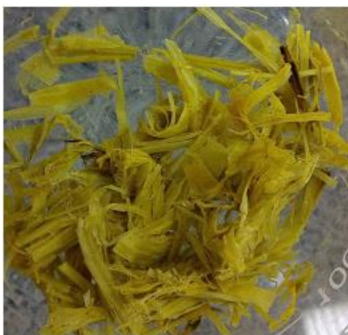
Figura 19– Amostra após hidrólise ácida e correção de pH
