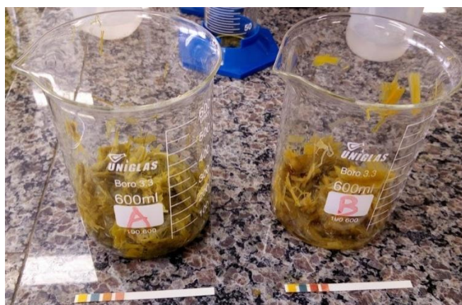
Figura 18– Amostras e seus respectivos papéis indicadores de pH após deslignificação.
