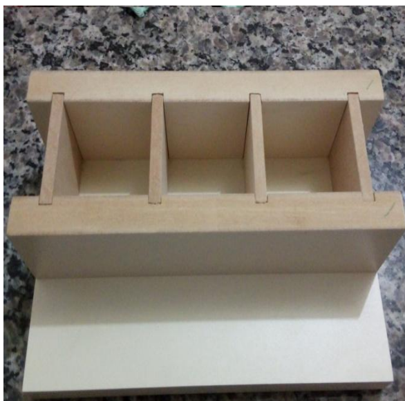
Figura 19 - Molde para corpos de prova para ensaios de compressão.
