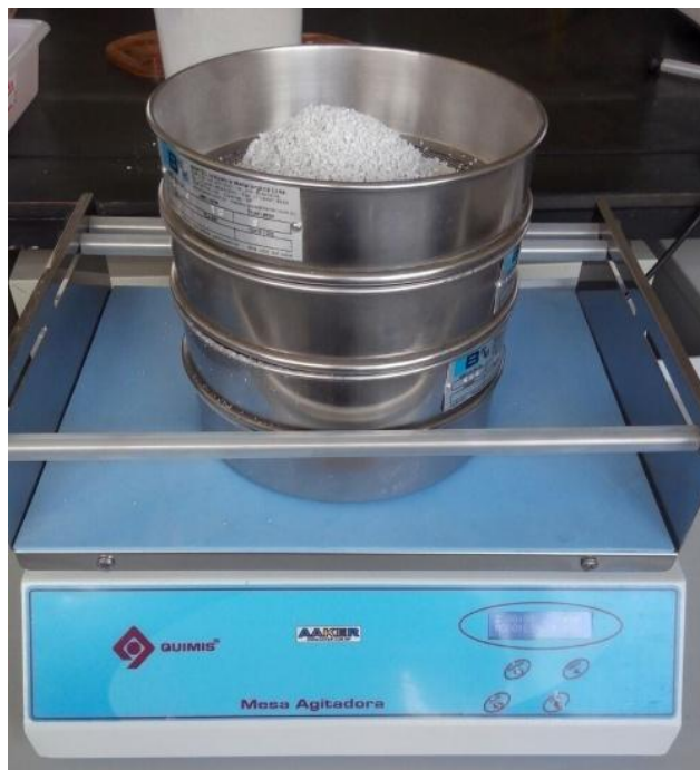
Figura 17 – Sistema de peneiramento.
