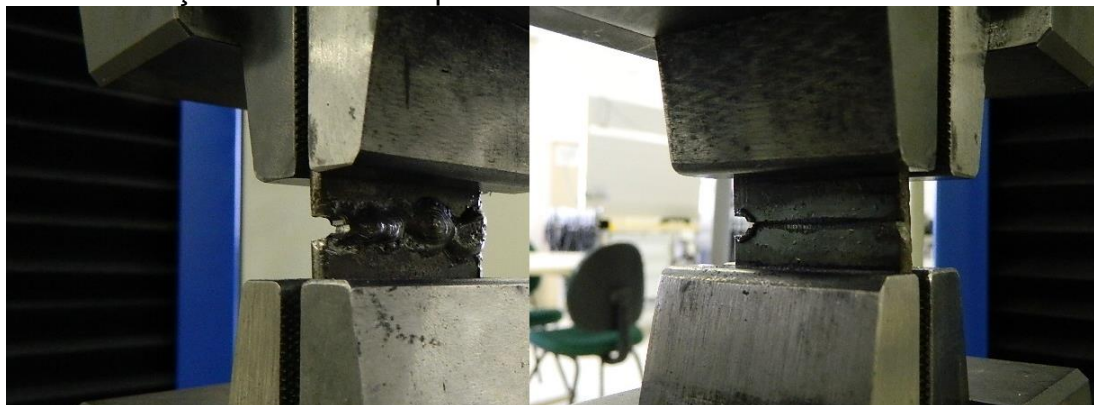
Figura 28 - Fixação do CP na máquina de ensaio
