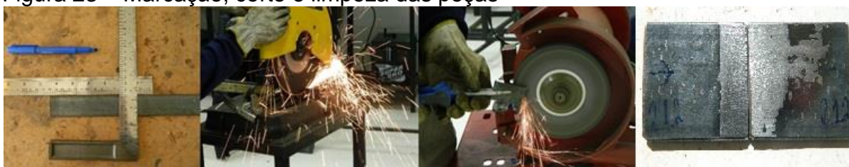
Figura 23 – Marcação, corte e limpeza das peças
