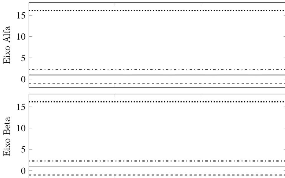
Fig. 47 – Resposta dos ganhos adaptativos  $\theta$  à variação abrupta da indutância da rede  $L_g$  quando a variável intermediária é a tensão do capacitor  $v_C$ .
