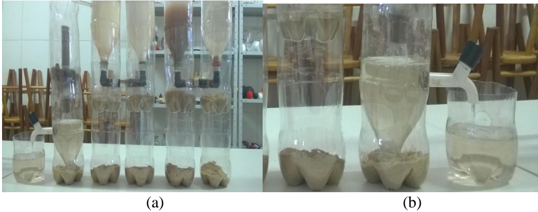
Figura 12 - (a) Demonstração do protótipo em funcionamento e (b) detalhe do processo de filtração
