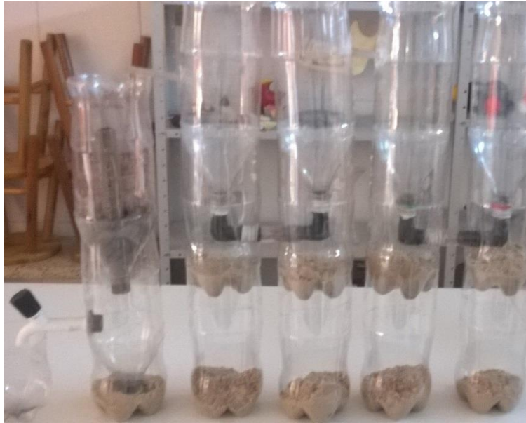
Figura 6 - Montagem do protótipo da ETA
