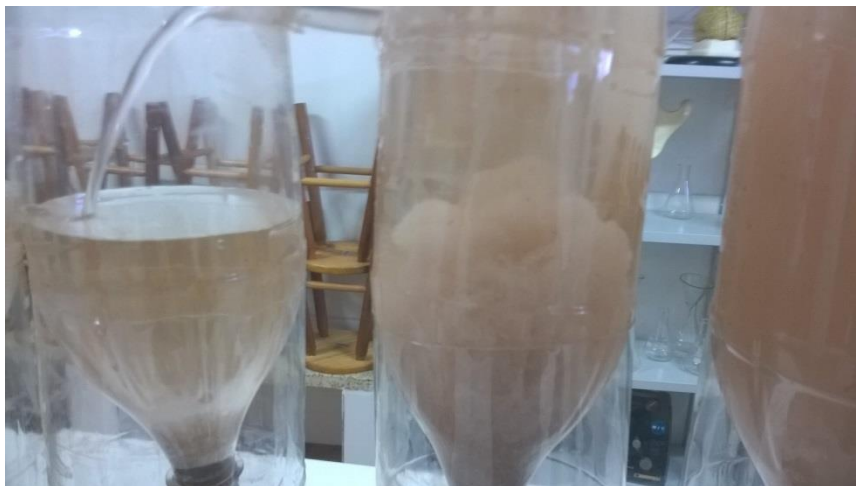
Figura 11 - Processo de floclação no protótipo da ETA
