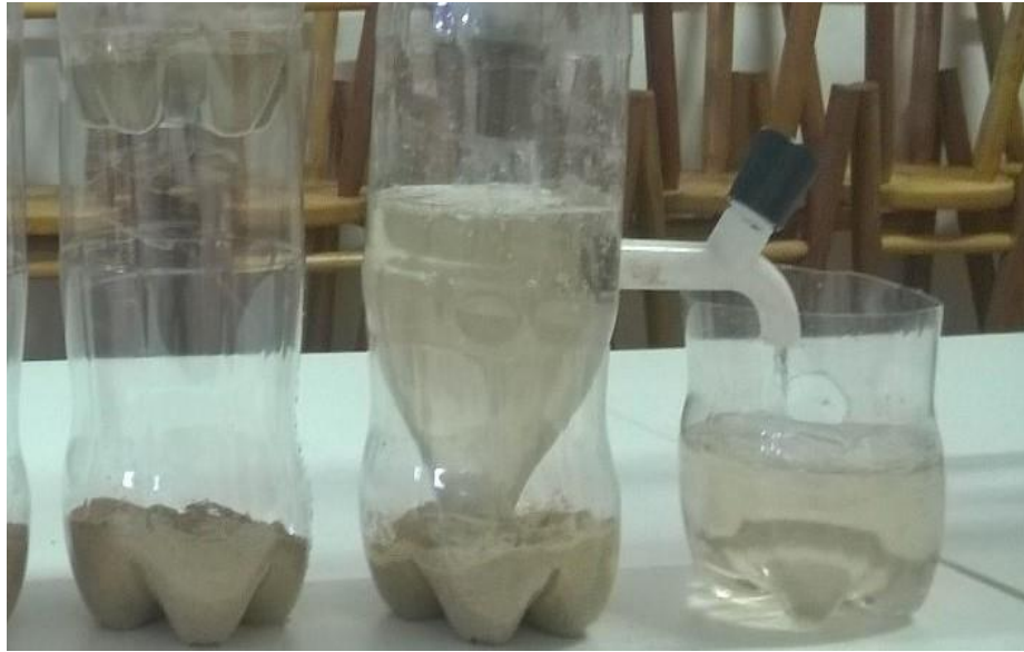
Figura 9- Processo de filtração no protótipo da ETA
