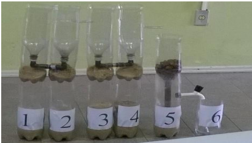
Figura 10 - Protótipo da Estação de Tratamento de Água montado
