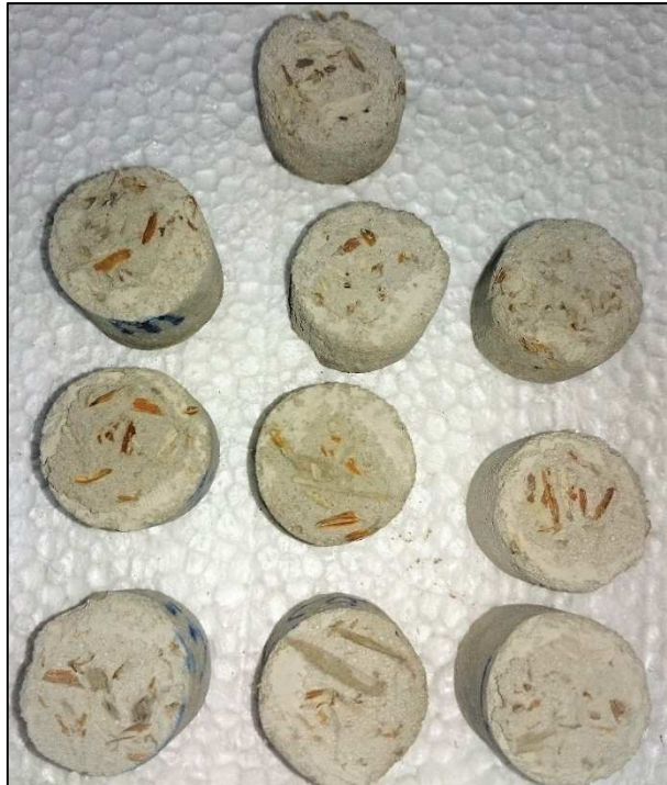
Figura 66 – Amostras do ensaio de absorção acústica seccionadas ao meio
