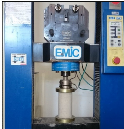
Figura 29 – Amostra em ensaio de resistência à compressão axial
