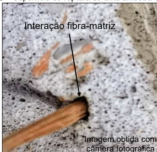
Figura 85 – Superfície de ruptura de uma amostra do T15.3S
