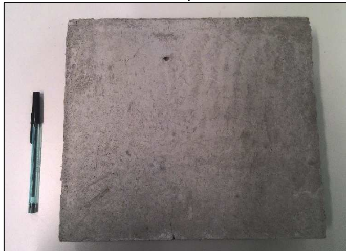
Figura 38 – Placa de 250 x 250 x 50 m 3 para ensaio de condutividade térmica
