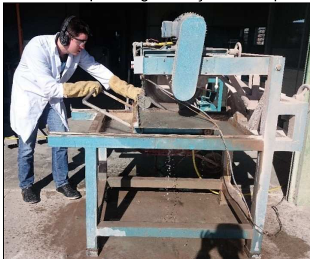
Figura 28 – Retífica utilizada para regularização das superfícies das amostras
