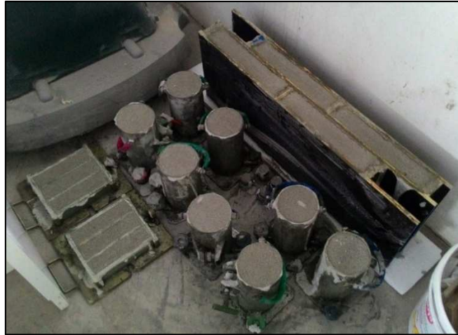
Figura 27 – Amostras em cura à temperatura ambiente
