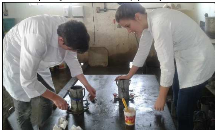
Figura 26 – Preparação dos moldes (aplicação do desmoldante)
