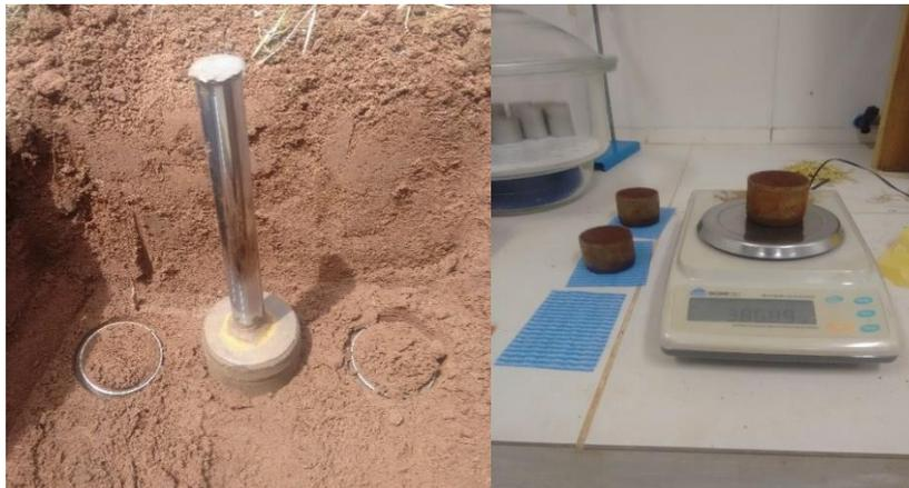
**Figura 3** - Procedimentos para coleta de amostra e pesagem das mesmas.
