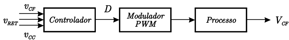
Figura 28 – Representação do sistema de controle em malha aberta proposto.
