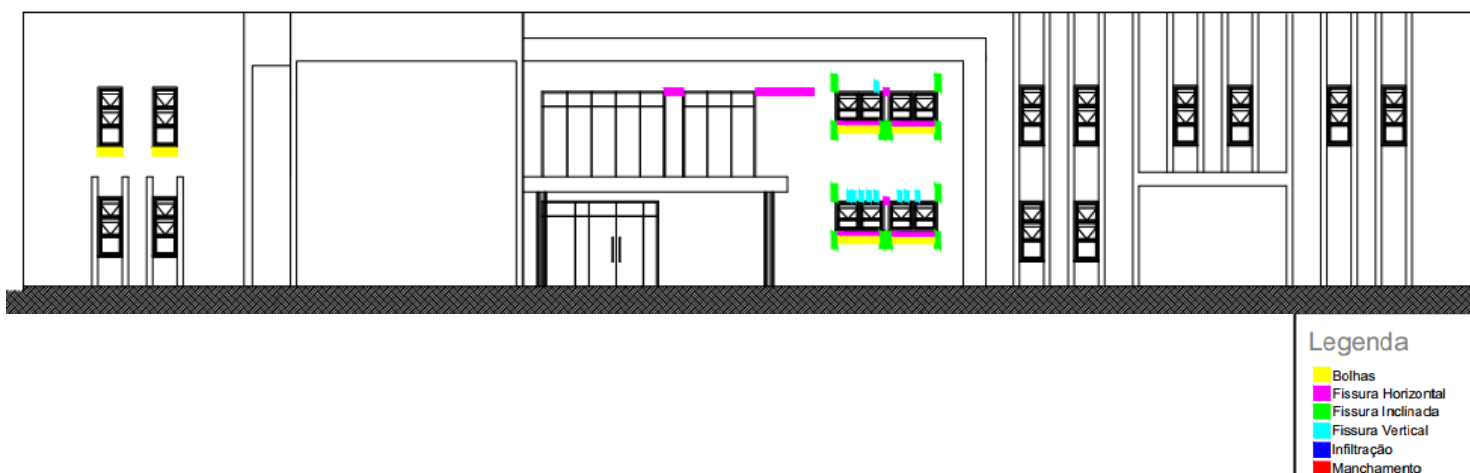
Figura 72-Mapa de incidência de danos fachada oeste
