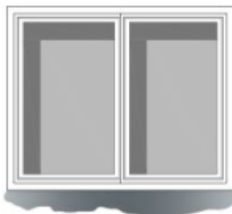
Figura 19-Infiltração nas interfaces do peitoril
