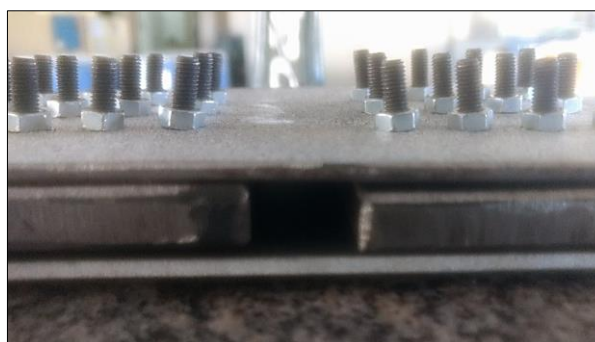
Figura 33 - Parafusos danificados (ligação do ensaio 5)
