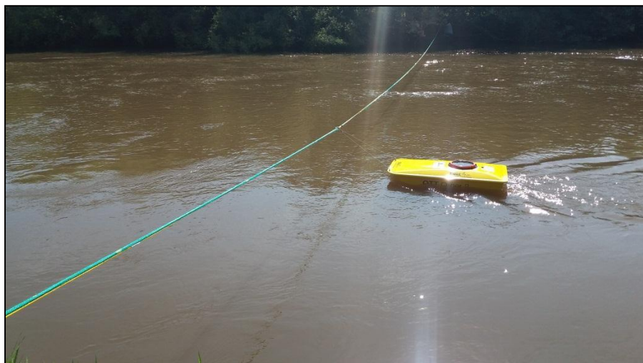
Figura 18 – Medição da vazão no Arroio Caverá com o equipamento OTT Qliner 2
