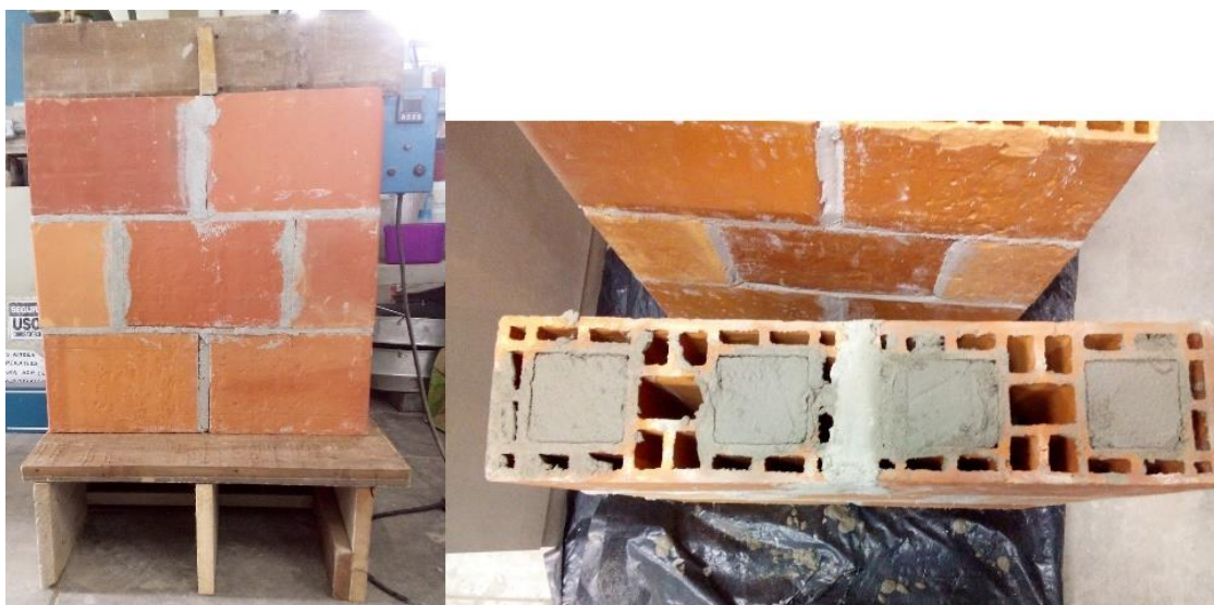
Figura 22 - Vista frontal e superior do prisma construído.
