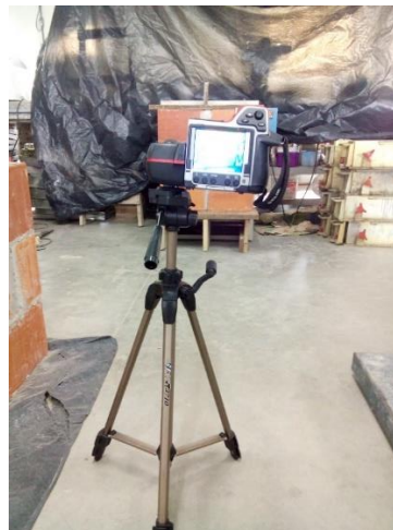
Figura 27 – Posicionamento da Câmera termográfica.
