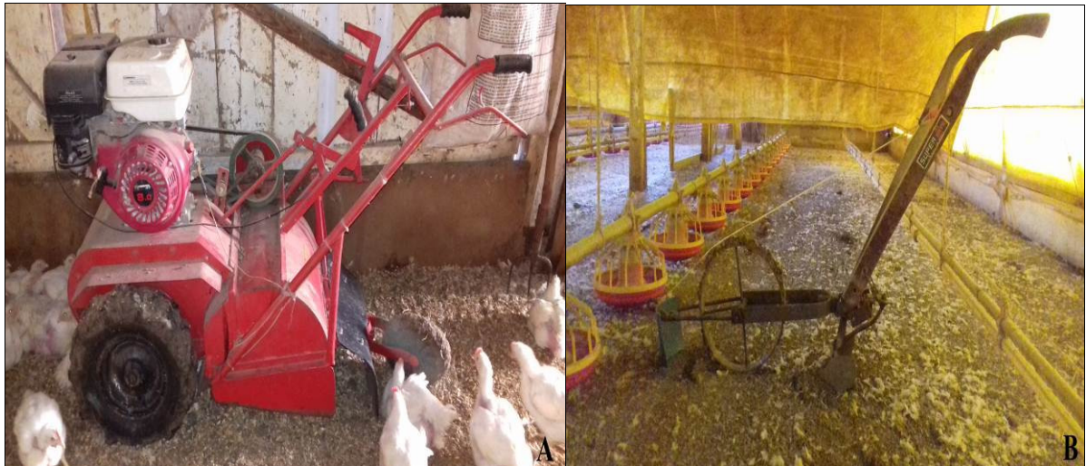
FIGURA 30 - Removedor de cama movido á gasolina (A), Removedor de cama manual (B). Fonte: Arquivo pessoal.
