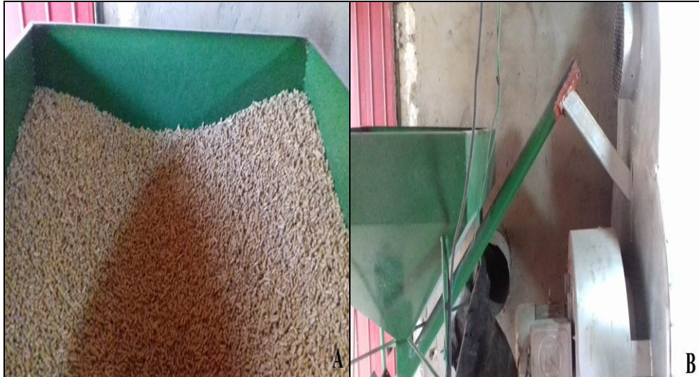
FIGURA 11 – Pellets (A), Silo acoplado na fornalha (B). Fonte: Arquivo pessoal.
