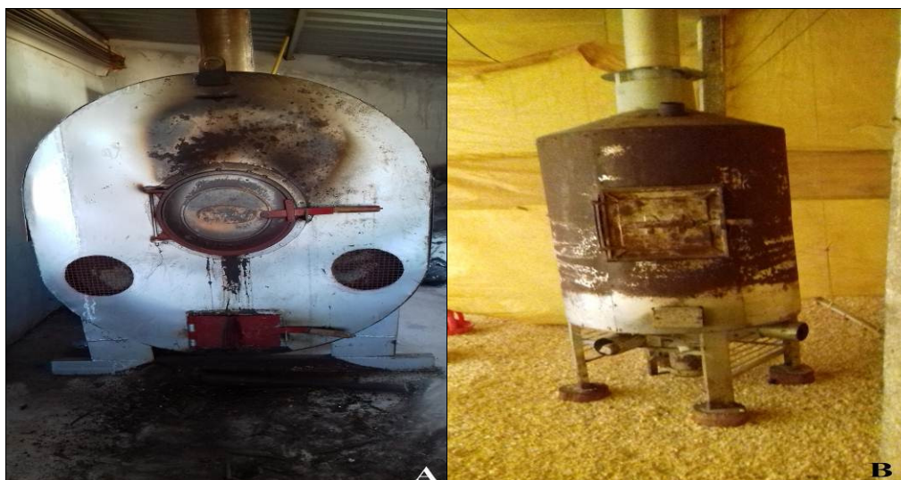
FIGURA 10 - Fornalha em sala adjacente (A), Fornalha de modelo mais antigo, instalada dentro do aviário (B). Fonte: Arquivo pessoal.
