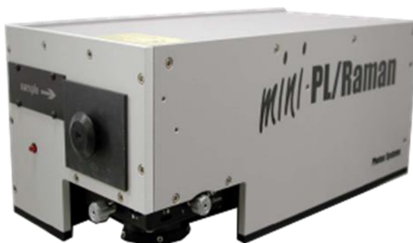
Figura 3.7: Mini PL/Raman, espectrômetro utilizado para realizar os experimentos de fotoluminescência.
