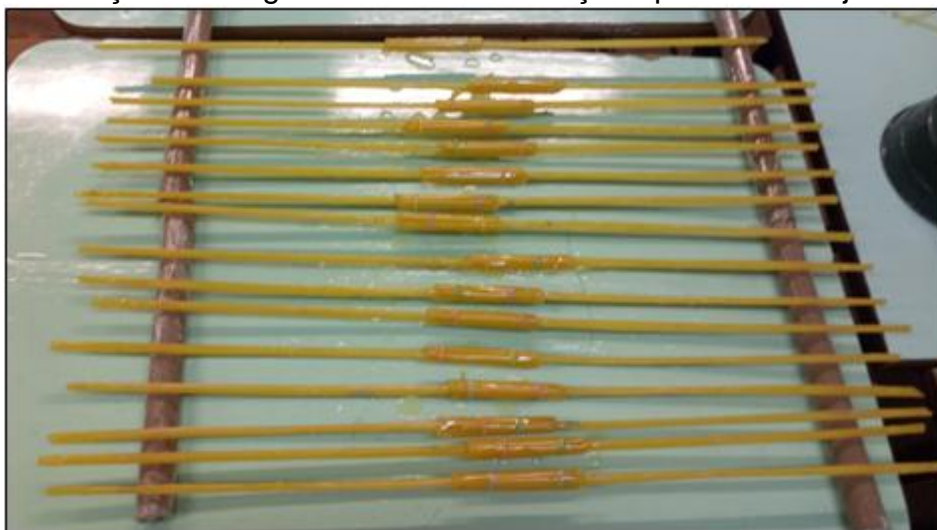
Figura 17 – Construção e secagem das barras de tração após feitas as juntas
