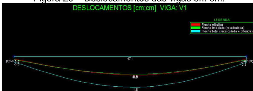
Figura 20 – Deslocamentos das vigas em cm.
