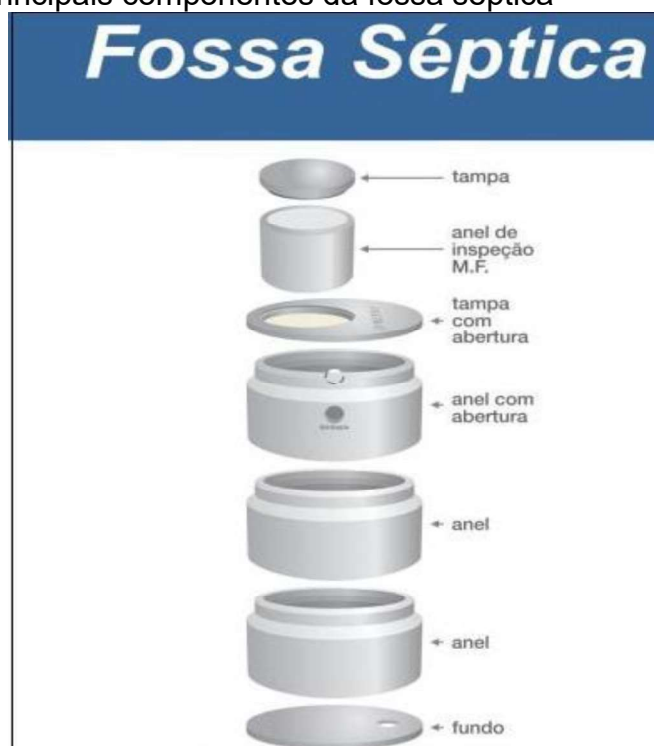
Figura 3 - Principais componentes da fossa séptica
