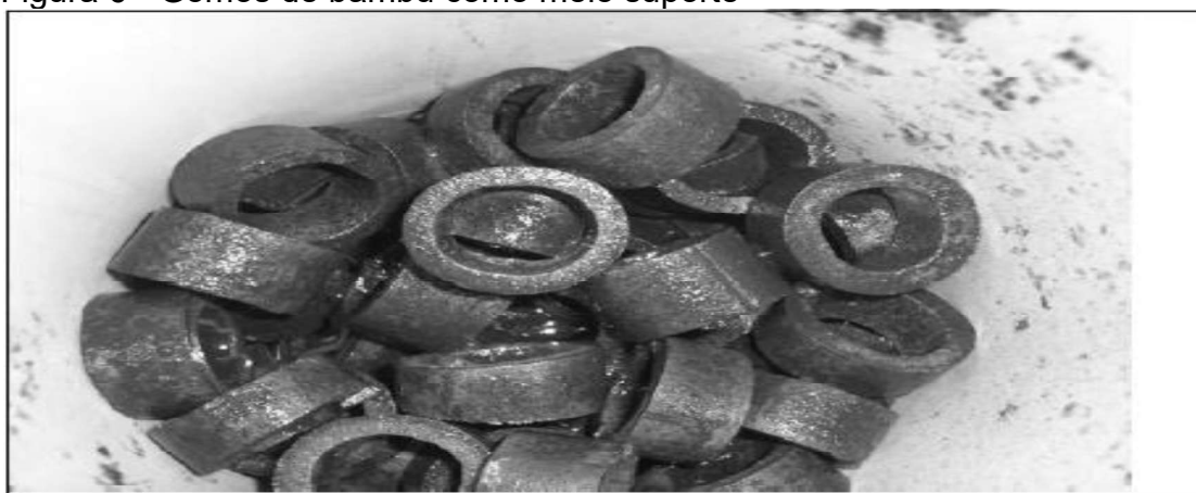
Figura 6 - Gomos de bambu como meio suporte
