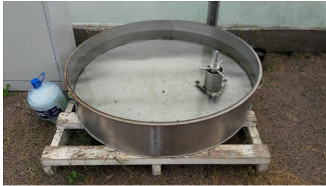
Figura 5 – Conjunto Tanque Classe A utilizado para cálculo da evapotranspiração da cultura.. Fonte: FERREIRA, 2016.
