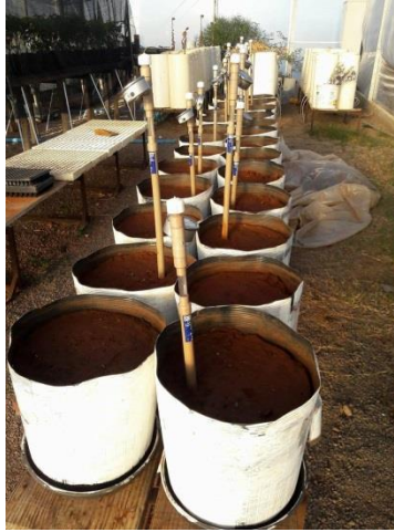
Figura 7 - Instalação dos tensiômetros a 8 cm de profundidade.
