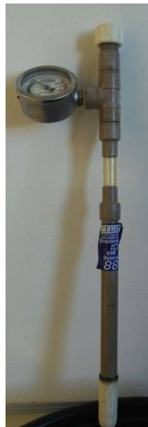
Figura 4 - Tensiômetro - Equipamento de medição indireta da tensão de água no solo.
