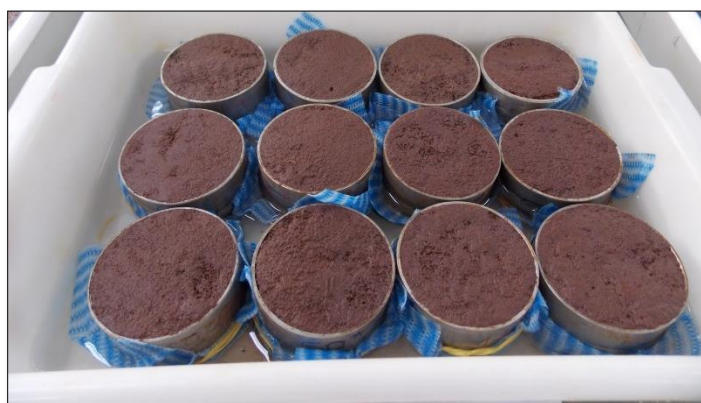
Figura 6- Amostras de solo saturadas. Fonte: Fonseca, J.
