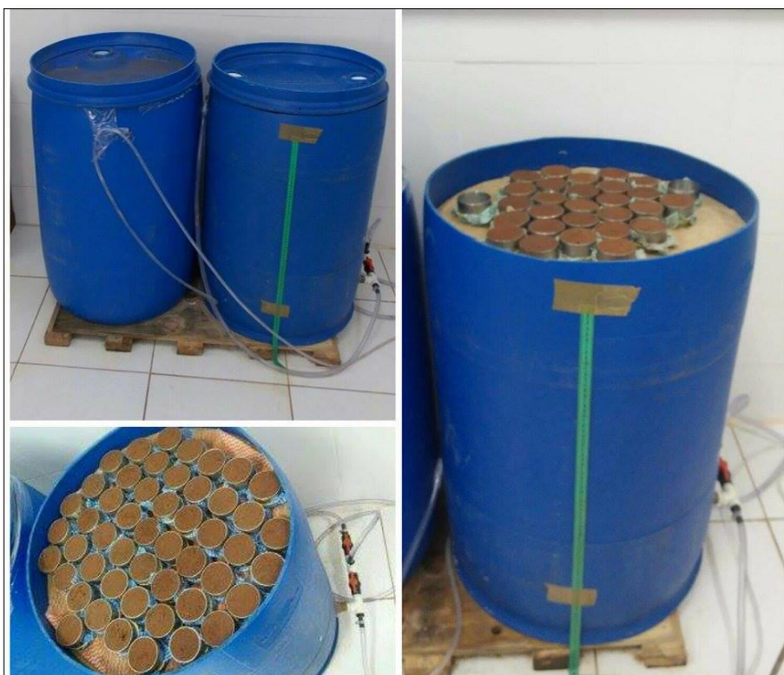
Figura 7-Coluna de areia, Método de Reinert & Reichert (2006). Fonte: Fonseca, J.
