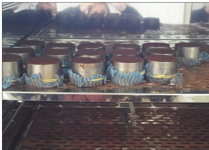
Figura 8- Amostras de solo indeformadas na estufa a 105°. Fonte: Fonseca, J.
