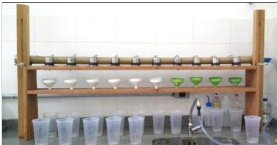
Figura 9- Ensaio de condutividade hidráulica. Fonte: Fonseca, J.
