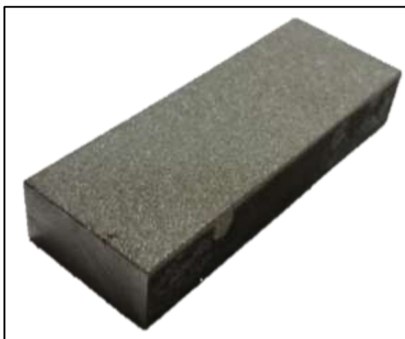
Figura 30 – Superfície jateada com granalha de alumina
