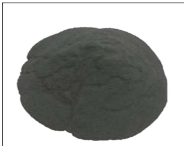
Figura 31 – Amostra de (Carbeto de Tungstênio 10%CoCr) em pó
