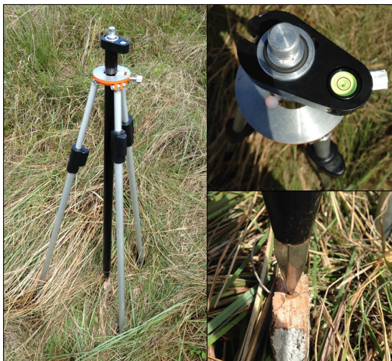
Figura 13 – Nivelamento do equipamento sobre o ponto de interesse.
