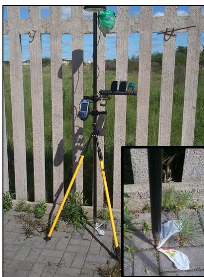
Figura 26 – Ocupação do receptor A (topográfico) com haste sobre o vértice materializado. Fonte: O autor.
