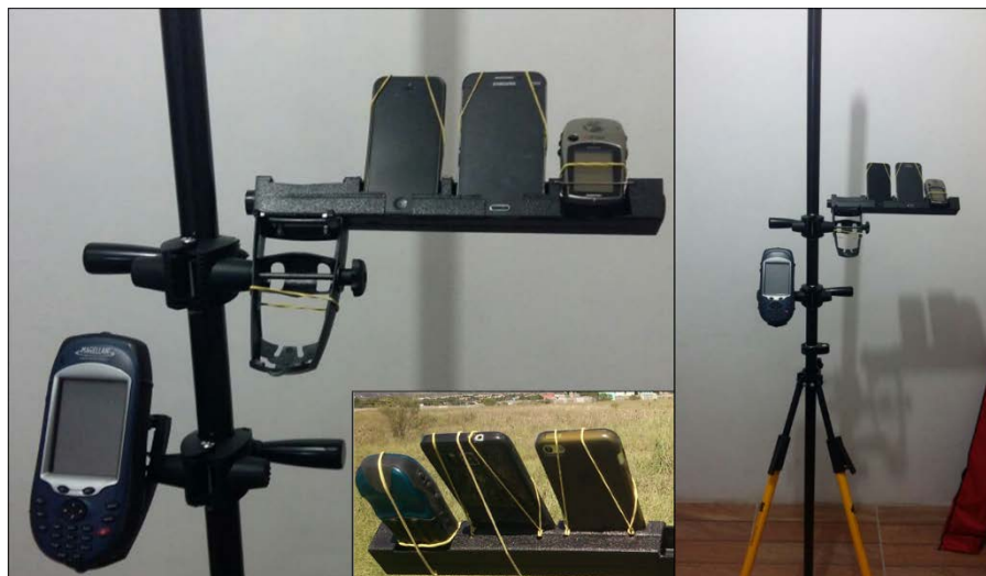
Figura 24 – Suporte de campo para coleta de dados e transporte dos receptores. Fonte: O autor.
