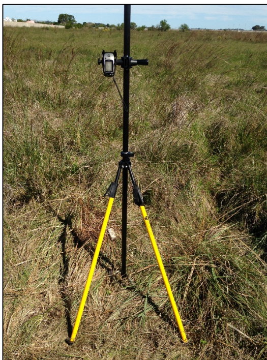
Figura 17 – Estrutura de apoio para as coletas. Fonte: O autor.
