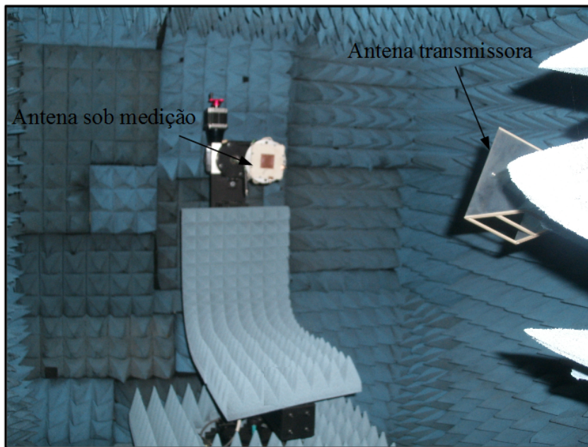
Figura 60 – Medição dos diagramas de irradiação do segundo protótipo.
