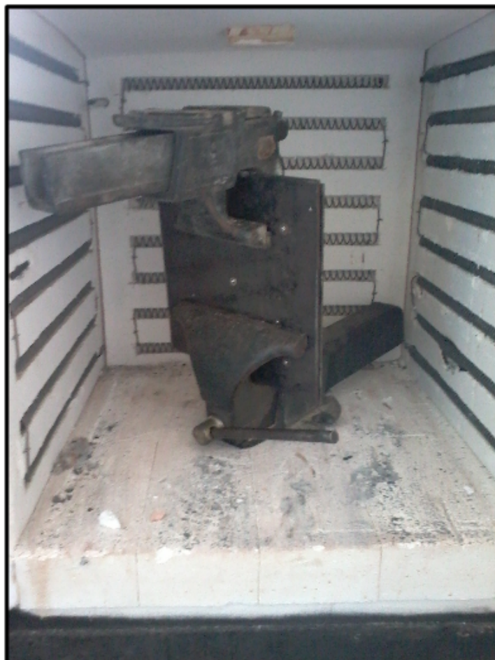
Figura 98 – Camadas da rede de antenas com a estrutura para pressionamento dentro do forno mufla.
