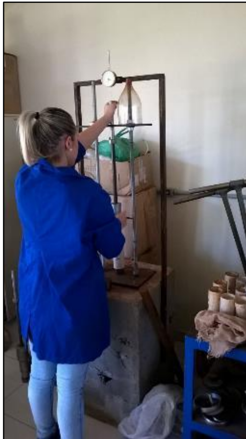
Figura 25 - Compactação com o equipamento miniatura
