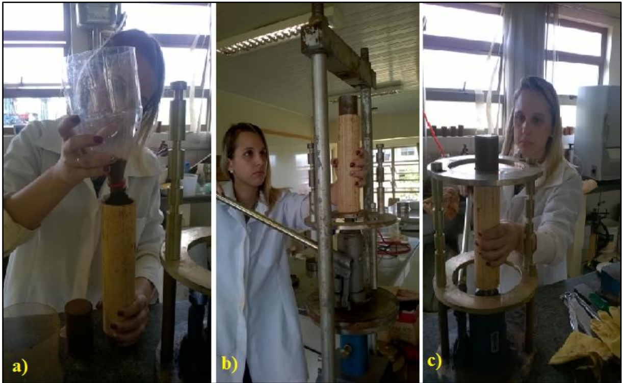
Figura 36 - a) Preparação para moldagem do corpo de prova 5 cm x 10 cm; b) compactação do CP; c) desmoldagem do CP
