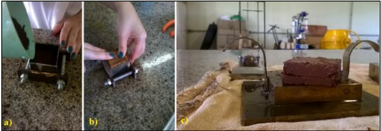
Figura 34 - a) Preparação do corpo de prova; b) corpo de prova pronto para ser compactado estaticamente; c) corpo de prova já ensaiado no equipamento de cisalhamento direto
