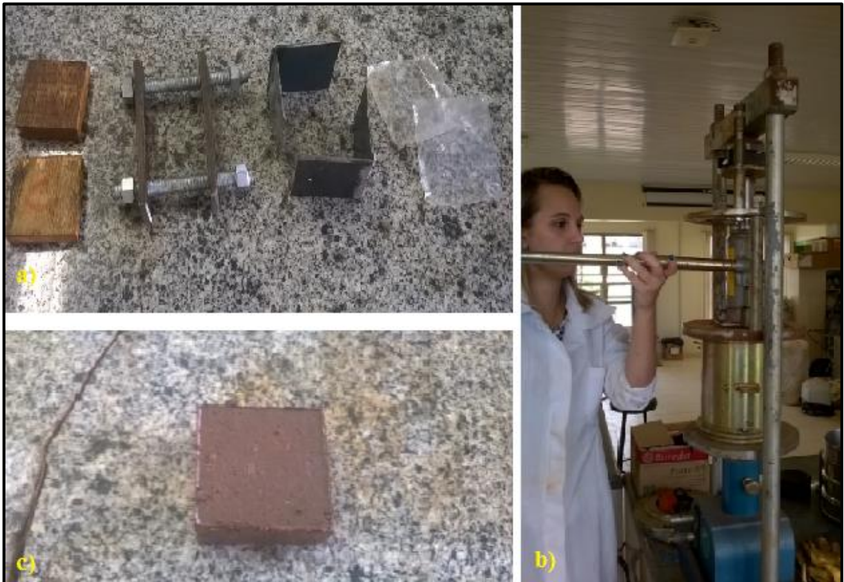
Figura 33 - a) Molde criado para compactação do corpo de prova; b) compactação estática; c) corpo de prova moldado com o molde metálico
