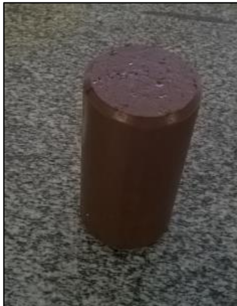
Figura 37 - Corpo de prova 5 cm x 10 cm para realização do ensaio de compressão triaxial
