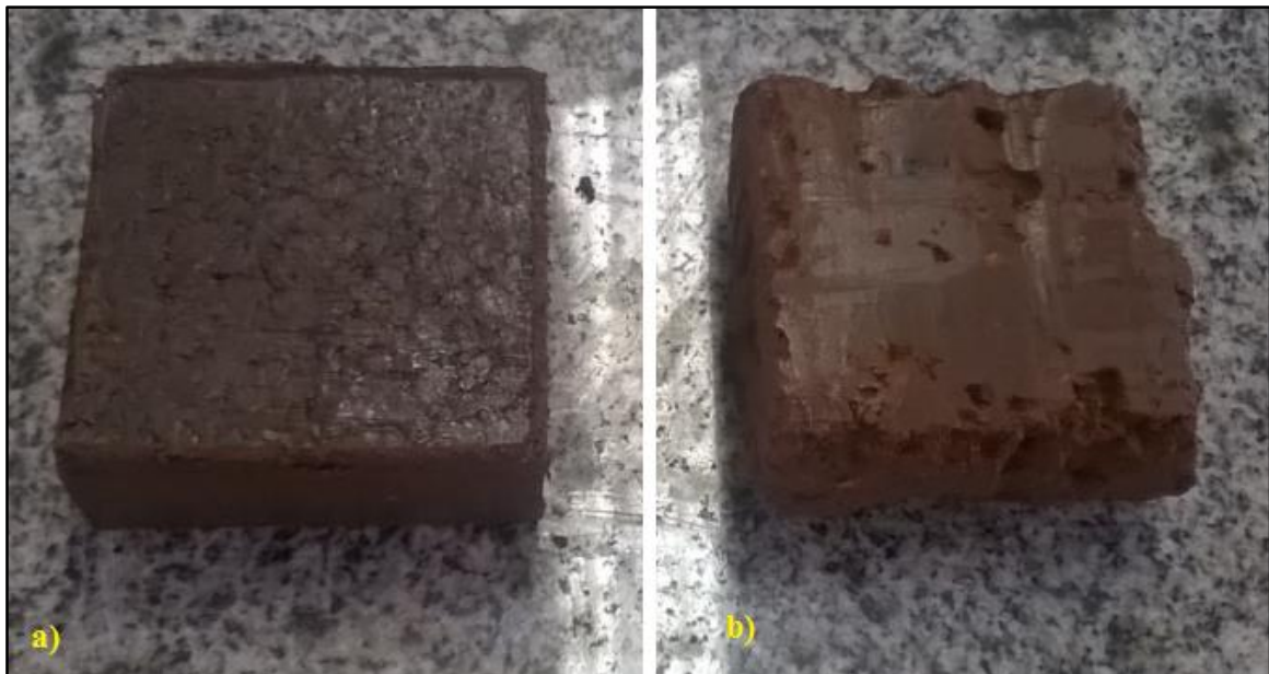
Figura 35 - a) Corpo de prova obtido com o molde criado; b) corpo de prova obtido a partir do CP cilíndrico
