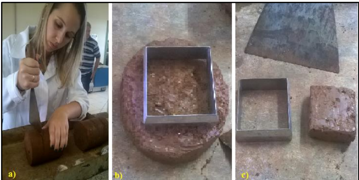
Figura 32 - a; b) CPs compactados no cilindro Proctor e separação das camadas do CP; c) CP do cisalhamento direto gerado a partir do CP cilíndrico
