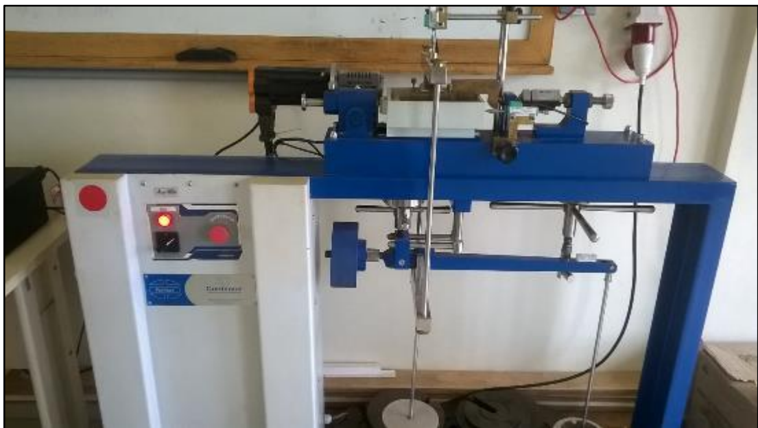
Figura 30 - Equipamento de cisalhamento direto
