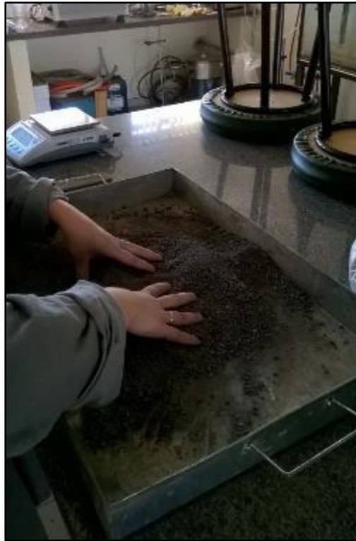
Figura 28 - Homogeneização das misturas
