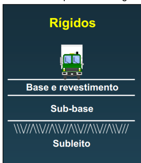
Figura 3 - Camadas constituintes dos pavimentos rígidos
