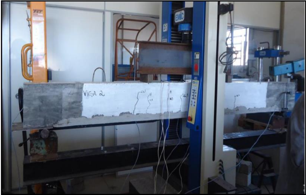
Figura 30 – Viga V2R já reforçada, pronta para ser ensaiada
