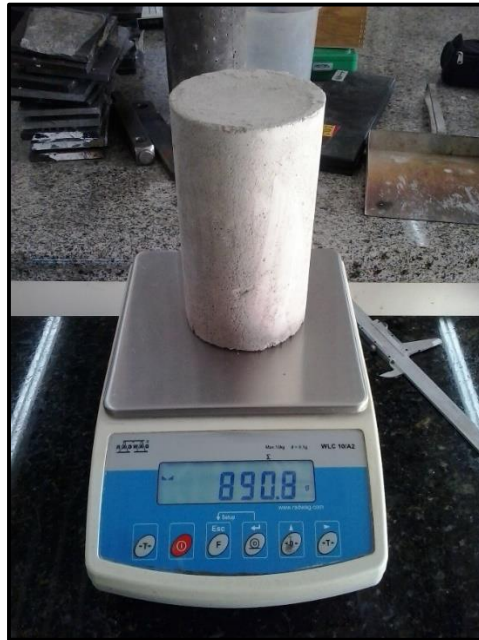
Figura 15 - Determinação da massa do concreto no estado endurecido
