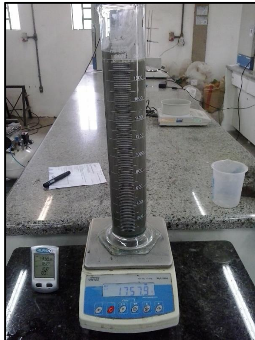
Figura 14 - Determinação da massa do concreto no estado fresco
