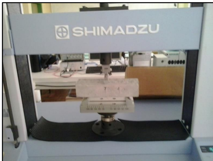
Figura 18 - Amostra em ensaio de flexão em 3 pontos
