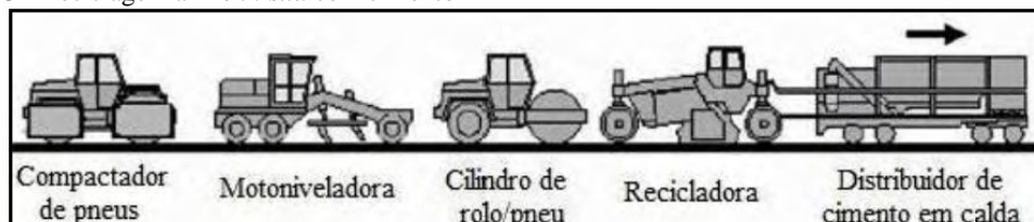
Figura 23 - Reciclagem a frio in situ com cimento
