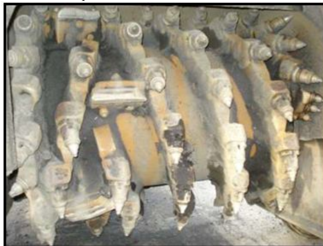
Figura 10 - Vista do tambor de uma máquina fresadora
