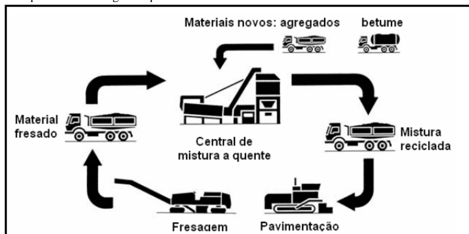
Figura 13- Esquema de reciclagem a quente em usina
