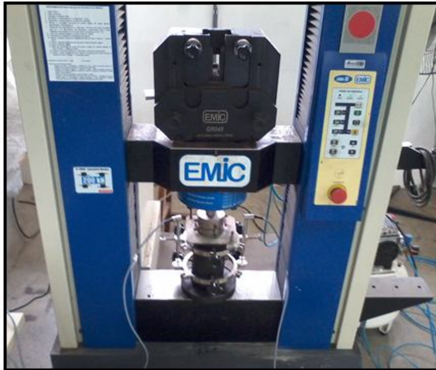
Figura 48 – Realização de Ensaio de Compressão
