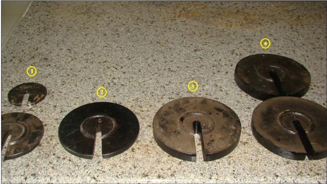
Figura 26 - Pesos Utilizados: (1) 25kPa; (2) 50kPa; (3) 100kPa e (4) 200kPa.
