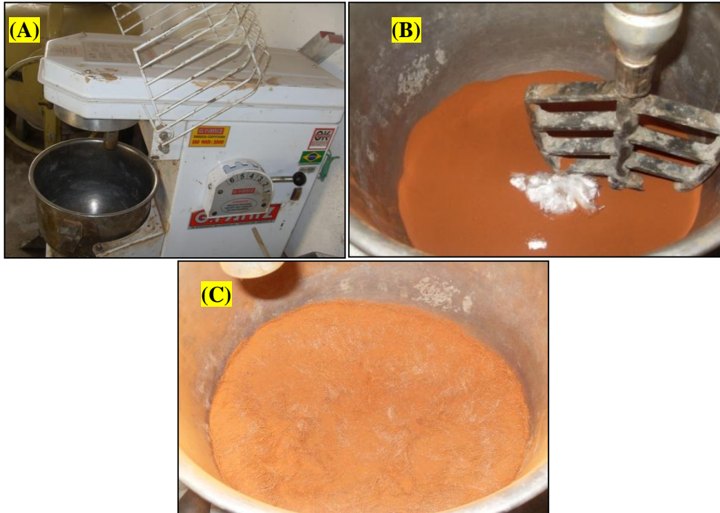
Figura 10 - (A) Batedeira planetária utilizada; (B) Amostra antes de misturada; (C) Amostra após 10 minutos na bateadeira planetária.
