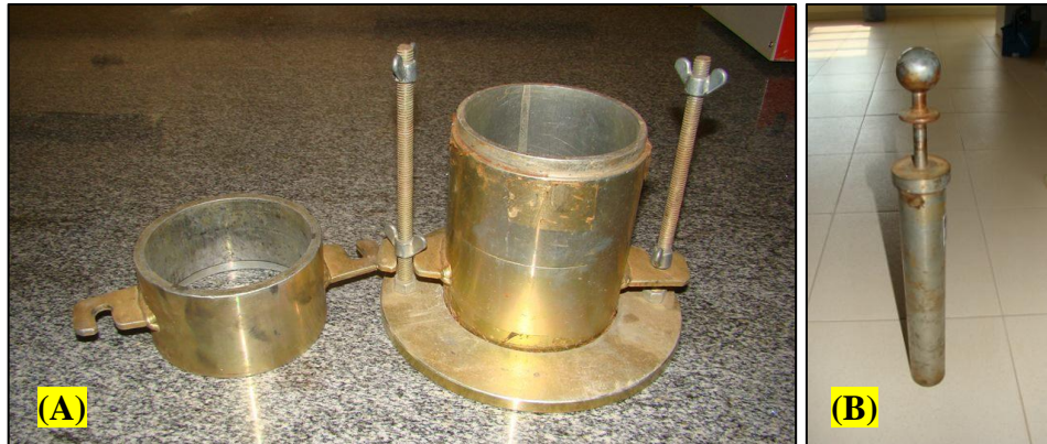
Figura 12 - (A) Molde Utilizado; (B) Soquete utilizado.
