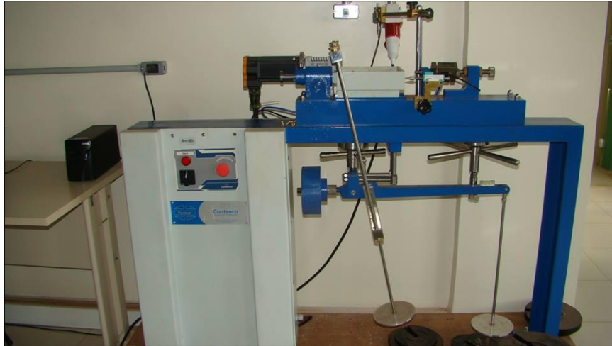
Figura 24 - Equipamento para ensaios de Cisalhamento Direto utilizado.
