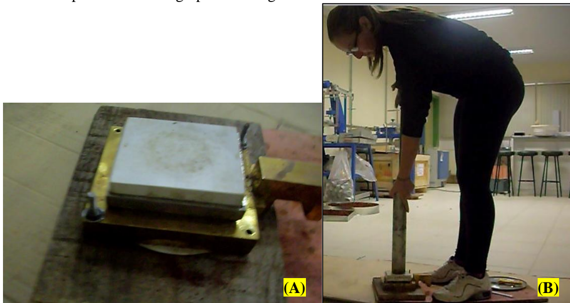
Figura 16 - Compactação Estática: (A) Tarugo de madeira disposto sobre amostra; (B) Amostra compactada com 16 golpes na energia normal do Proctor.
