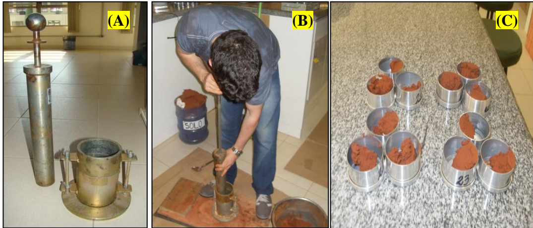
Figura 21 - Ensaio de Compactação: (A) Materiais Utilizados; (B) Realização do ensaio; (C) Amostras.
