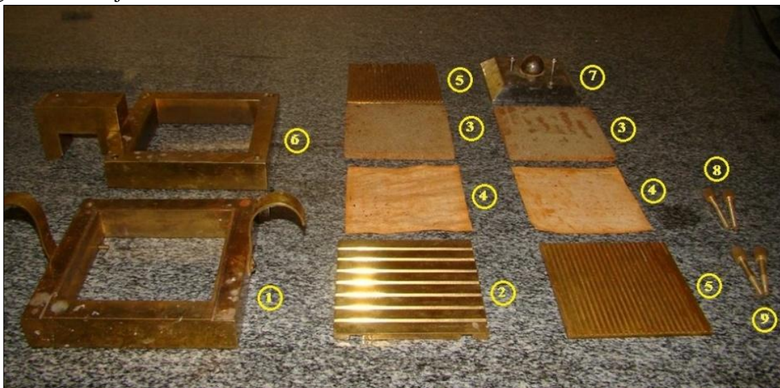
Figura 23 - Conjunto da célula de ensaio
