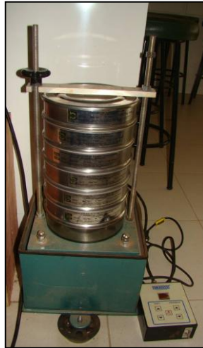
Figura 18 - Realização do Ensaio de Análise Granulométrica.
