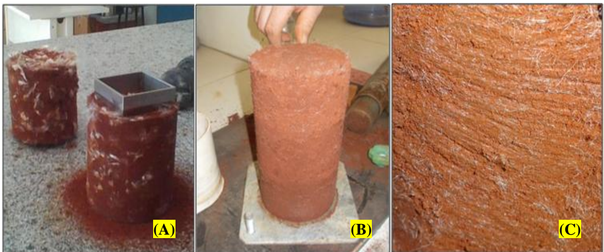
Figura 9 - (A) CP moldado com fibras mal abertas; (B) CP moldado com fibras bem abertas; (C) Detalhe da abertura e distribuição das fibras.
