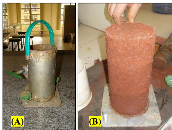
Figura 13 - (A) Cilindro usado na compactação, energia normal do Proctor; (B) Corpo de Prova obtido.
