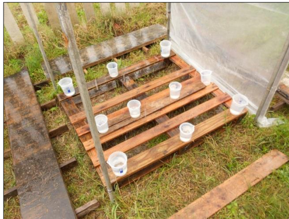
Figura 14 - Calibração do simulador, utilizando copos graduados
