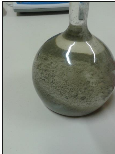
Figura 22 – Ensaio massa específica cinza volante
