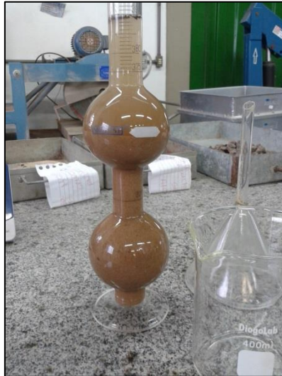
Figura 16 – Ensaio massa específica da areia
