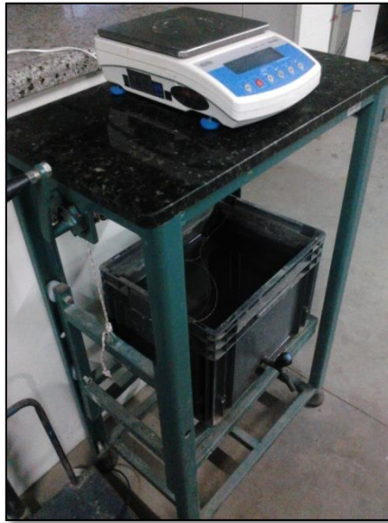
Figura 18 – Ensaio massa específica agregado graúdo
