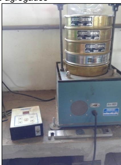
Figura 14 – Peneiramento dos agregados
