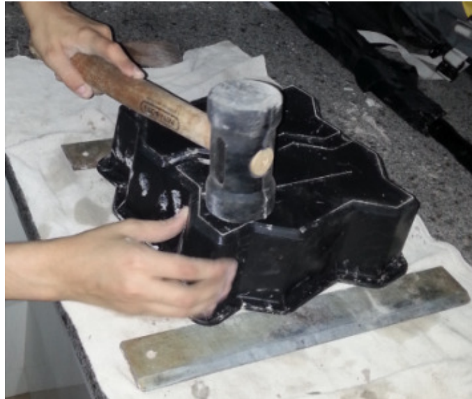
Figura 14: Desmoldagem dos pavers
